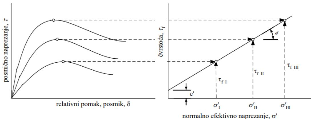
Slika 16 - Određivanje envelope sloma uređajem na 3 slična uzorka pri različitim početnim normalnim naprezanjima [16]
