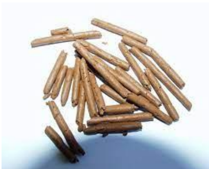
Slika 7 – Valjčići tla na granici plastičnosti [12]
