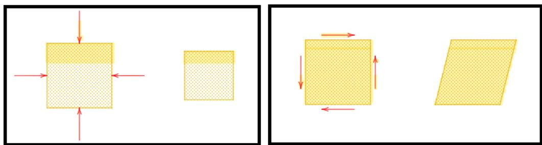
Slika 11 - kompresija (lijevo) uzrokovana normalnim naprezanjem je promjena volumena bez promjene oblika, a distorzija (desno) uzrokovana posmičnim naprezanjem je promjena oblika bez promjene volumena [7]
