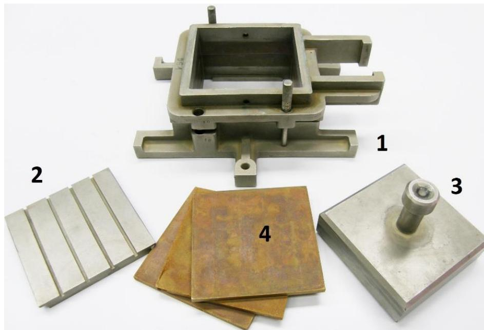
Slika 15 – čelija uređaja za test izravnog posmika (1-okviri kutije za smicanje, 2-donja ploča kutije sa zasjecima za dreniranje tekućine, 3-gornja ploča kutije, 4- nazubljeni šupljikavi kamen)[10]
