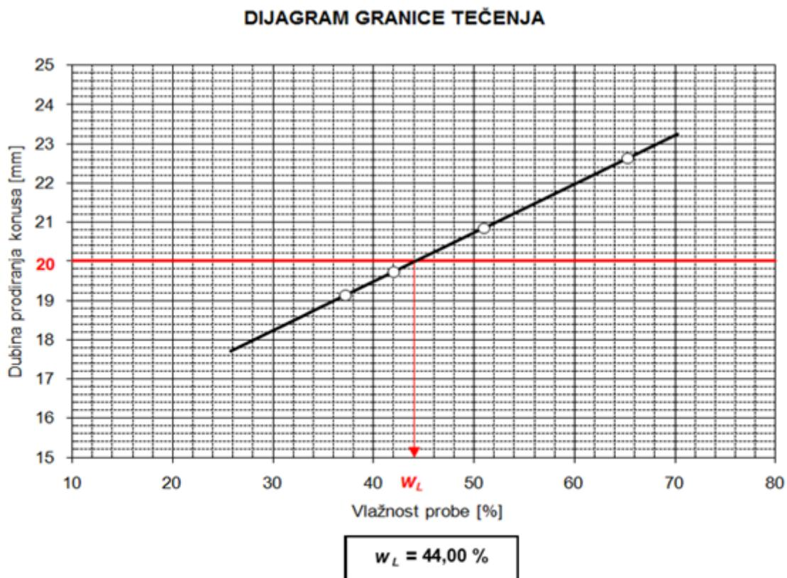
Slika 6 - dijagram dobiven penetracijskim testom tla.[10]
