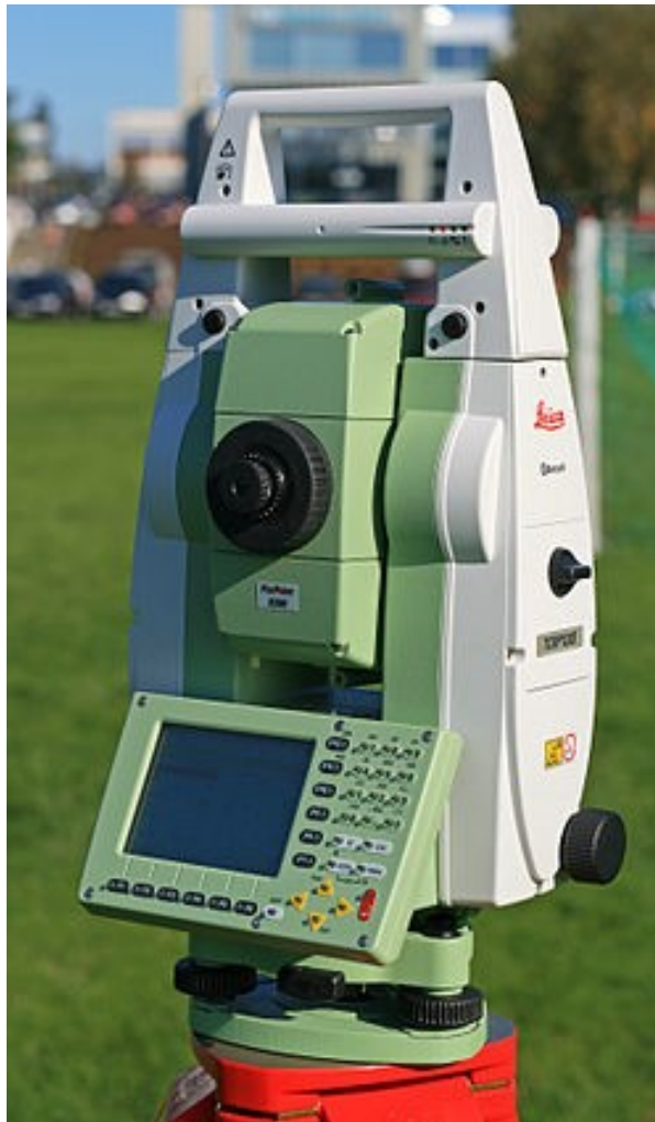
Slika 1. Mjerna stanica Leica Viva TS16 [10]
