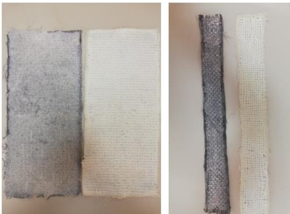
Slika 11 Korišteni \text{TiO}_2 (bijela mreža) i \text{TiO}_2/\text{CNT} (crna mreža) fotokatalizatori za FPCR reaktor (lijeva slika) i CPC reaktor (desna slika)
