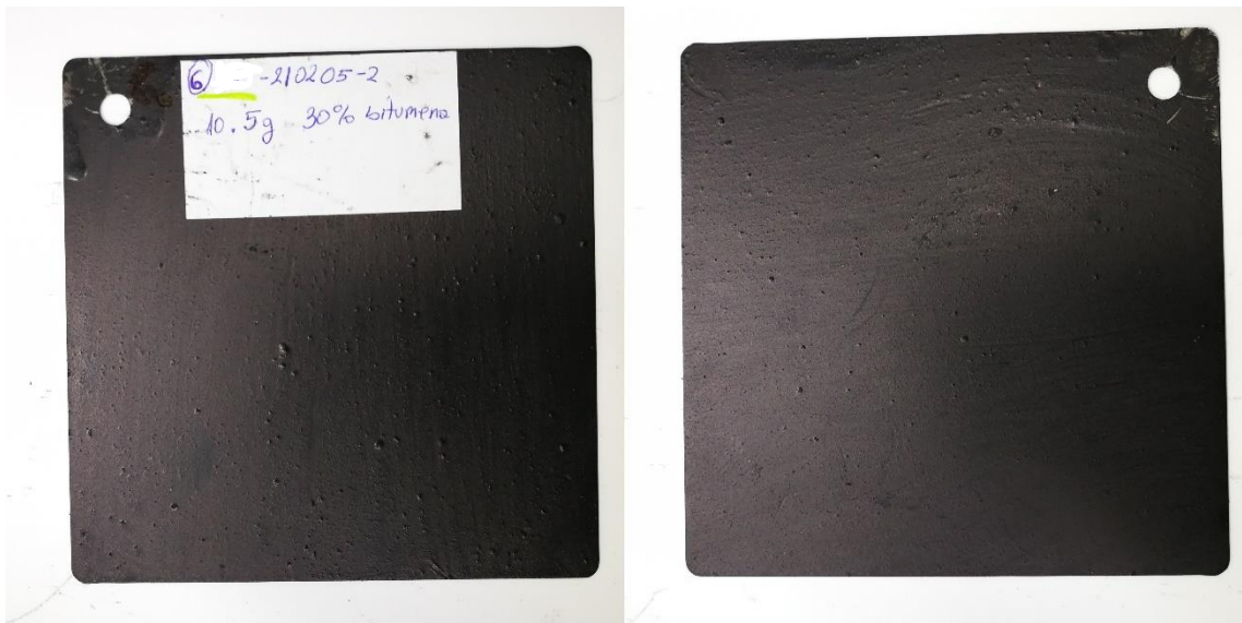
Slika 43. Pločica premazana destilacijskim muljem FP1-210205-2 s dodatkom 30% bitumena
