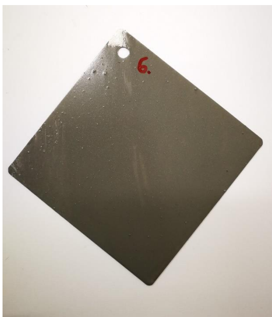
Slika 32. Pločica premazana destilacijskim muljem AM1-210201-1 bez prethodne nadorade dodatkom bitumena
