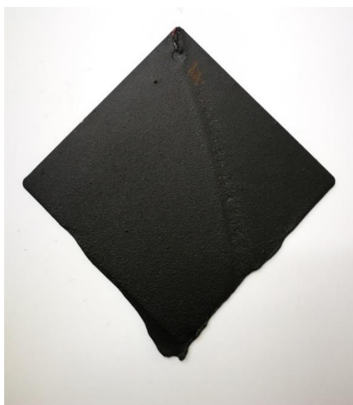
Slika 26. Pločica premazana destilacijskim muljem FP3 -210202-1 bez nadorade
