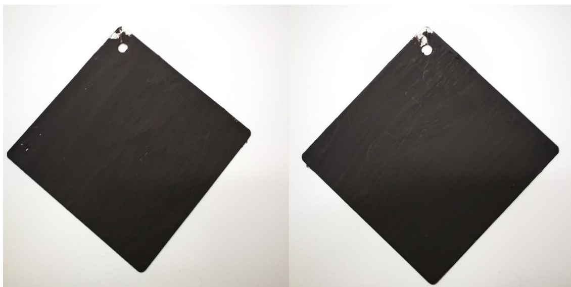
Slika 27. Pločica premazana destilacijskim muljem FP3-210202-1 u koji je dodano 5% regenerata
