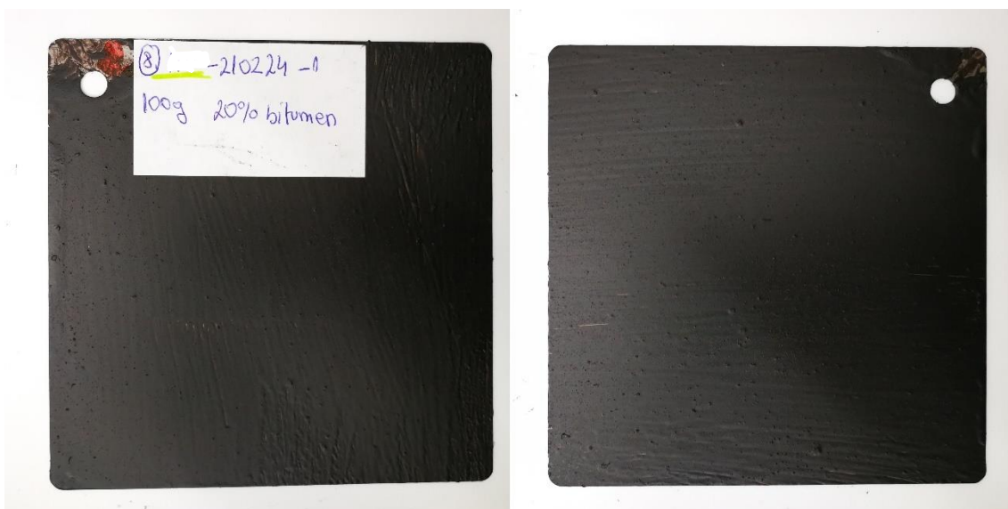
Slika 46. Pločica premazana destilacijskim muljem FP2-210224-1 s dodatkom 20% bitumena
