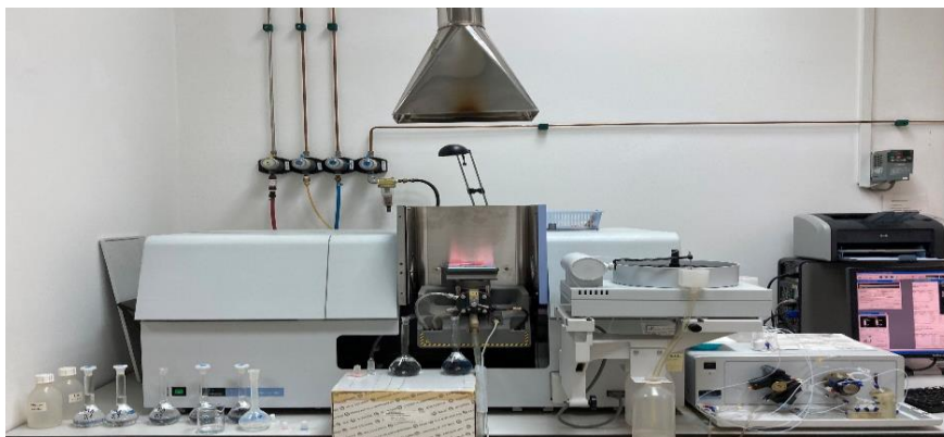
Slika 15. Atomski apsorpcijski spektrometar AAnalyst 800
