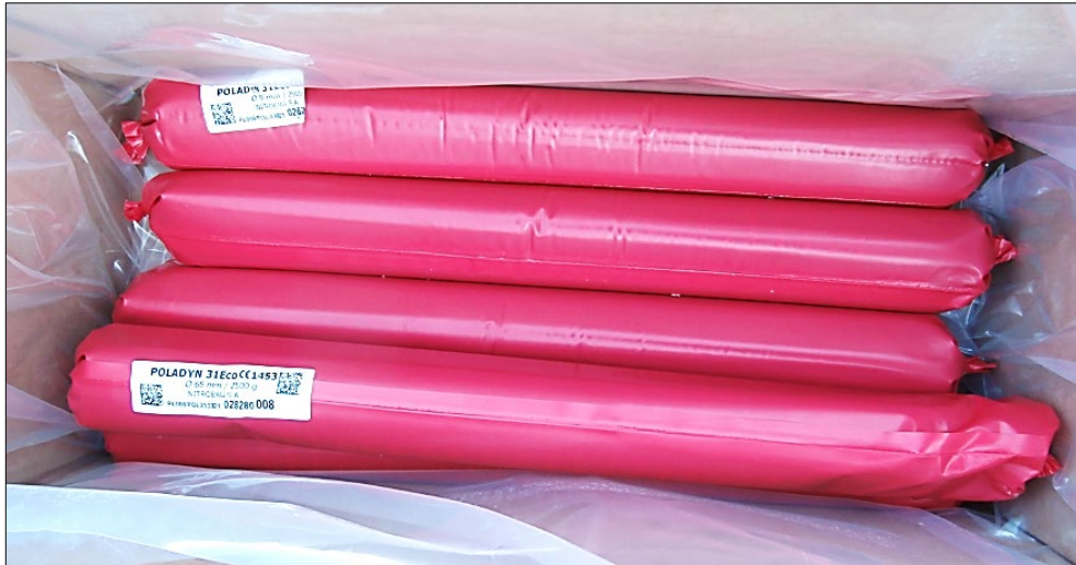
Slika 9. Patronirani plastični eksploziv „POLADYN 31 ECO“
