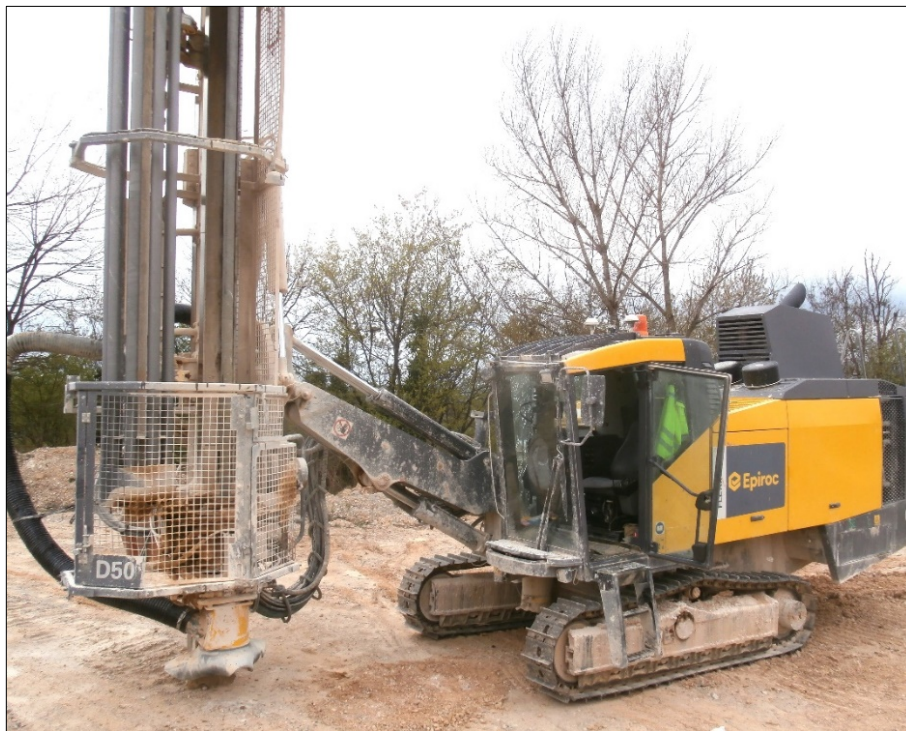
Slika 11. Dubinska hidraulička bušilica na gusjenicama Epiroc D50 u kamenolomu „Špica“
