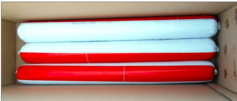
Slika 8. Patronirani emulzijski eksploziv „RIOHIT ST“
