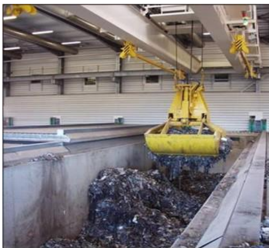
Slika 2. Premještanje bioosušenog otpada procesnim kranom iz betonske komore (Preuzeto iz: Hidroplan d.o.o., 2014.)
