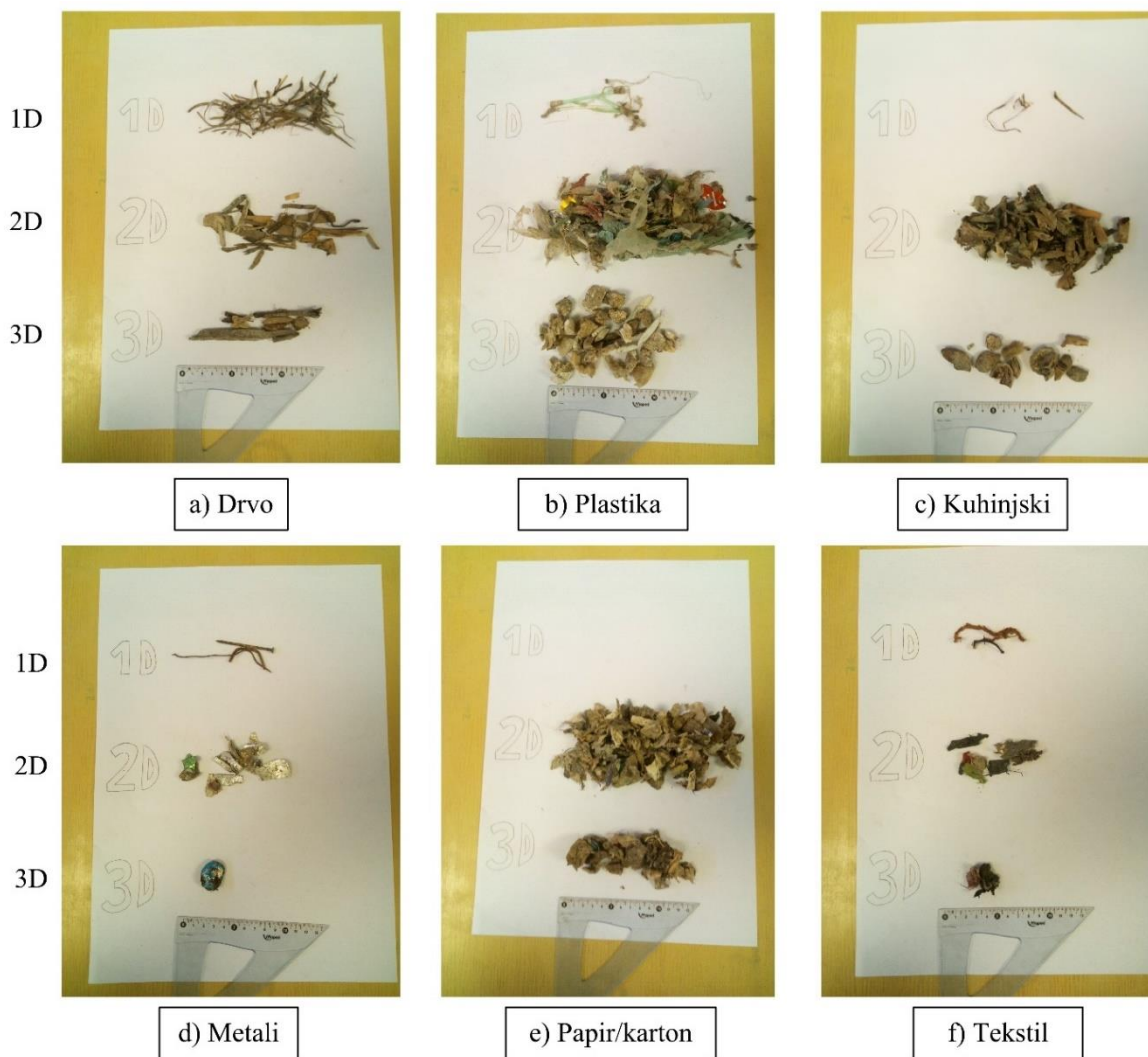
Slika 28. Komponente otpada uzorka A1 razvrstane prema obliku čestica na 1D, 2D i 3D
