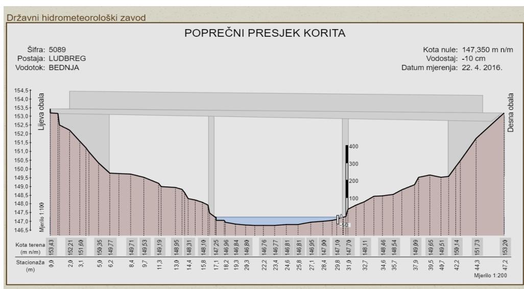
Slika 12. Poprečni presjek korita vodotoka Bednje (izvor: <https://hidro.dhz.hr/>)
