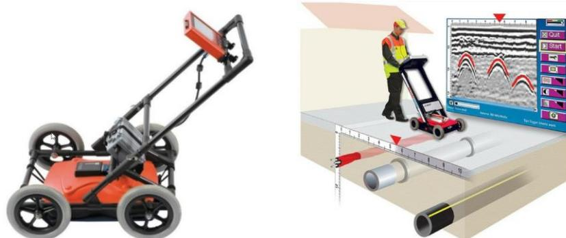
Slika 14. Georadar i princip istraživanja metodom georadara [15]
