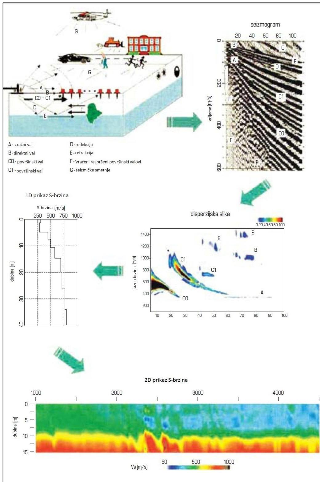
Slika 13. Primjer mjerena i analize podataka pomoću aktivne MASW metode [15]
