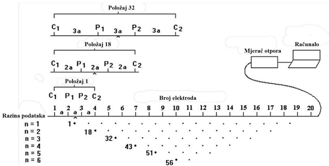
Slika 10. 2-D geoelektrična tomografija (Wennerov raspored elektroda) [15]
