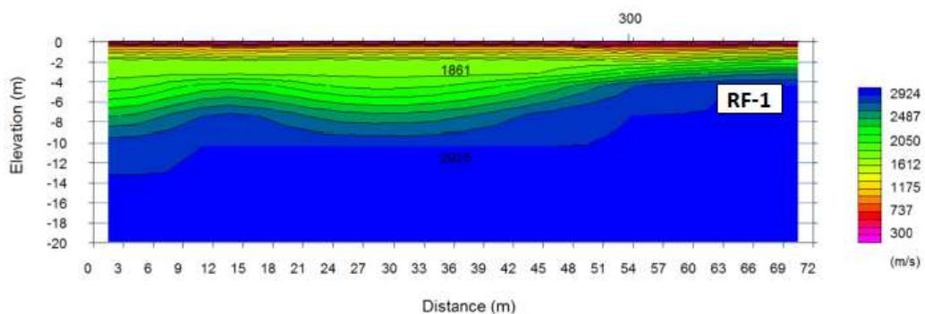
Slika 22. 2-D profil brzina seizmičkih valova izmjerena na RF-1, Korčula
