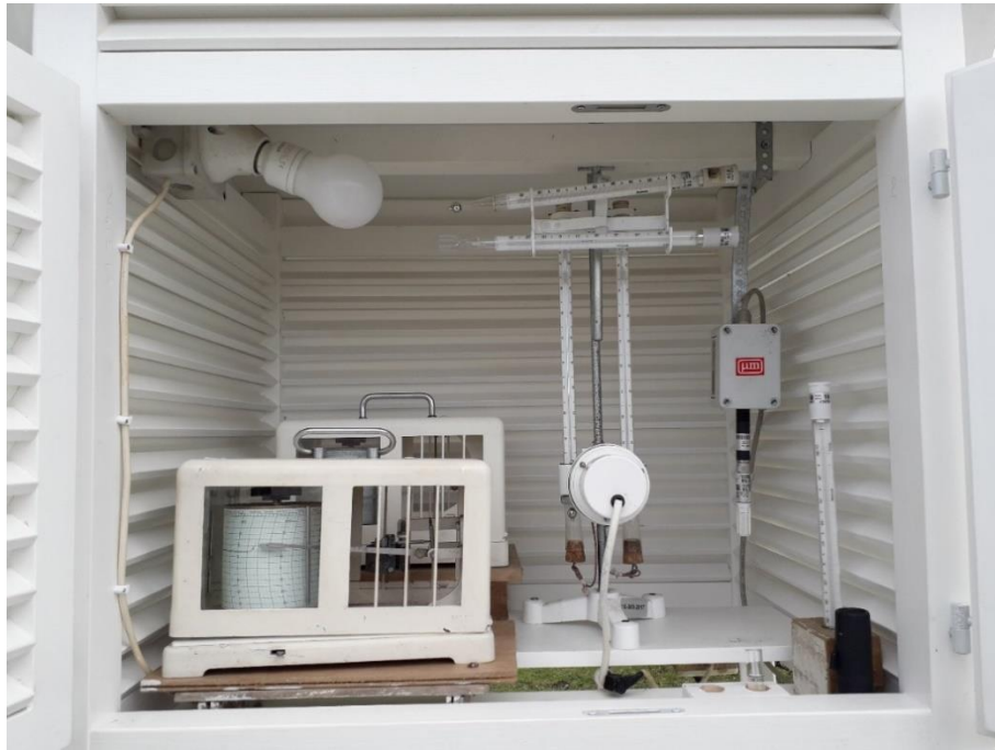
Slika 3. Prikaz unutrašnjosti termometrijske kućice [12]
