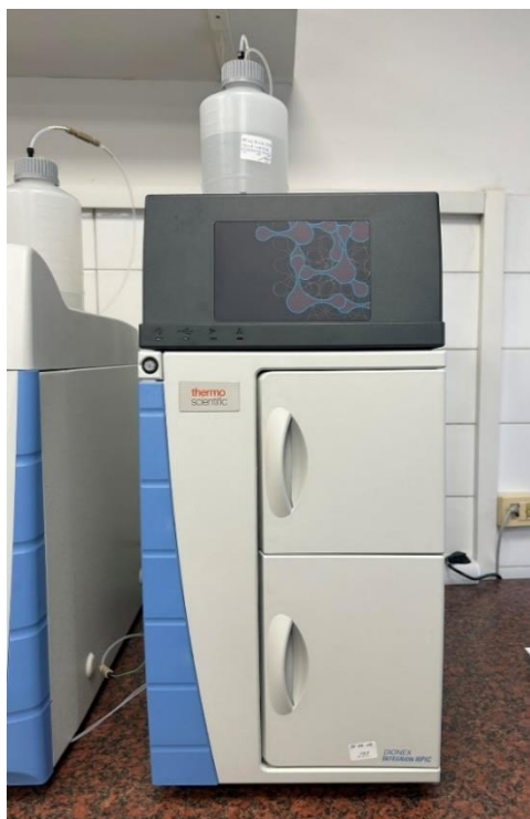
Slika 16. Ionski kromatograf Dionex Integrion HPIC
