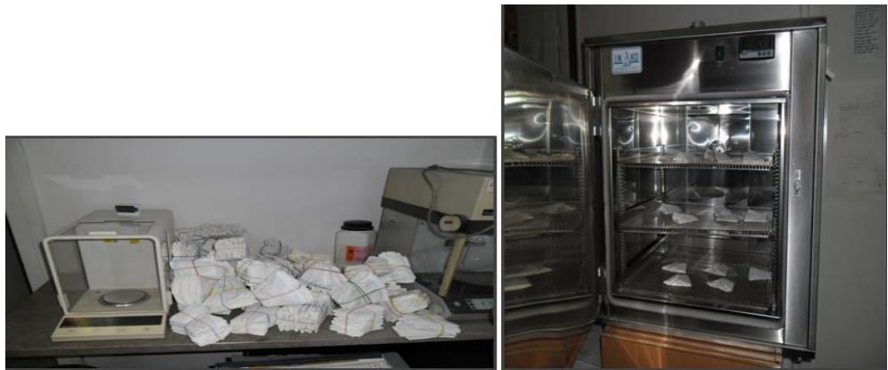
**Slika 20.** Laboratorijska obrada dnevnik uzorka filter papira s mjernih postaja, sušenje uzorka u laboratoriju DHMZ-a [31]
