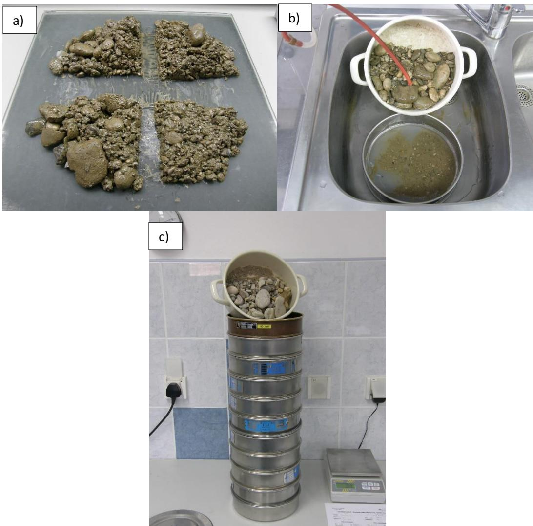
**Slika 32.** Postupak granulometrijske analize zrna nanosa većih od 0,063 mm:
