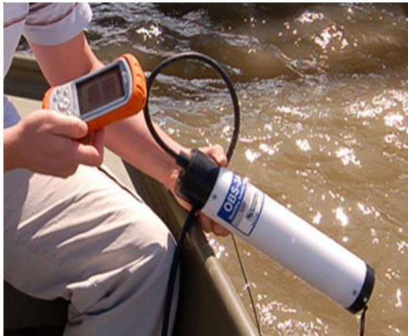
**Slika 21.** Optički senzor za mjerjenje mutnoće
