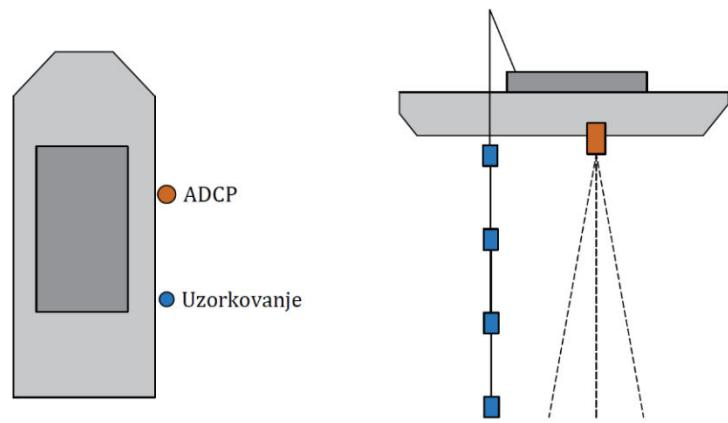
**Slika 24.** Shematski prikaz načina mjerjenja ADCP - om i uzimanje uzorka po vertikali [34]
