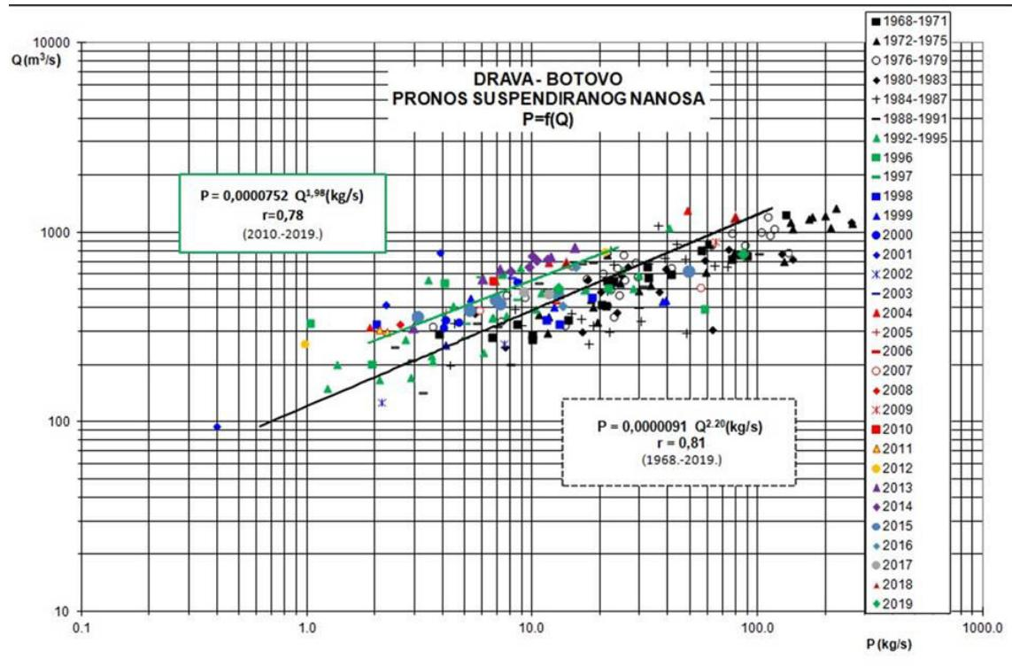
**Slika 27.** Korelacija između trenutnog pronosa suspendiranog nanosa  $P$  [kg/s] i protoka  $Q$  [ $\text{m}^3/\text{s}$ ] za razdoblje mjerjenja 1968. – 2019. HP Drava – Botovo
