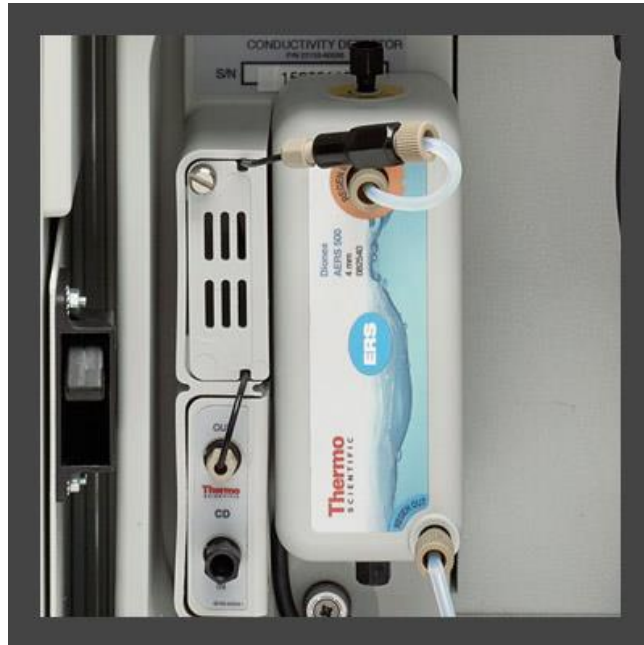
Slika 21. Detektor na Ionskom kromatografu “Thermo Scientific” Dionex Integrion HPIC
