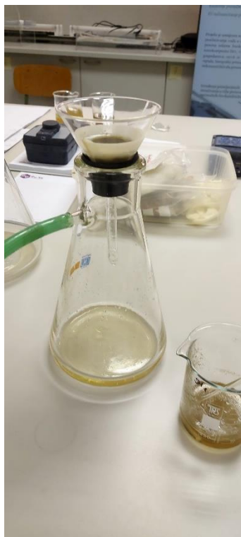
Slika 14 Filtracije obrađene (mljevene) sirove vune nakon adsorpcije
