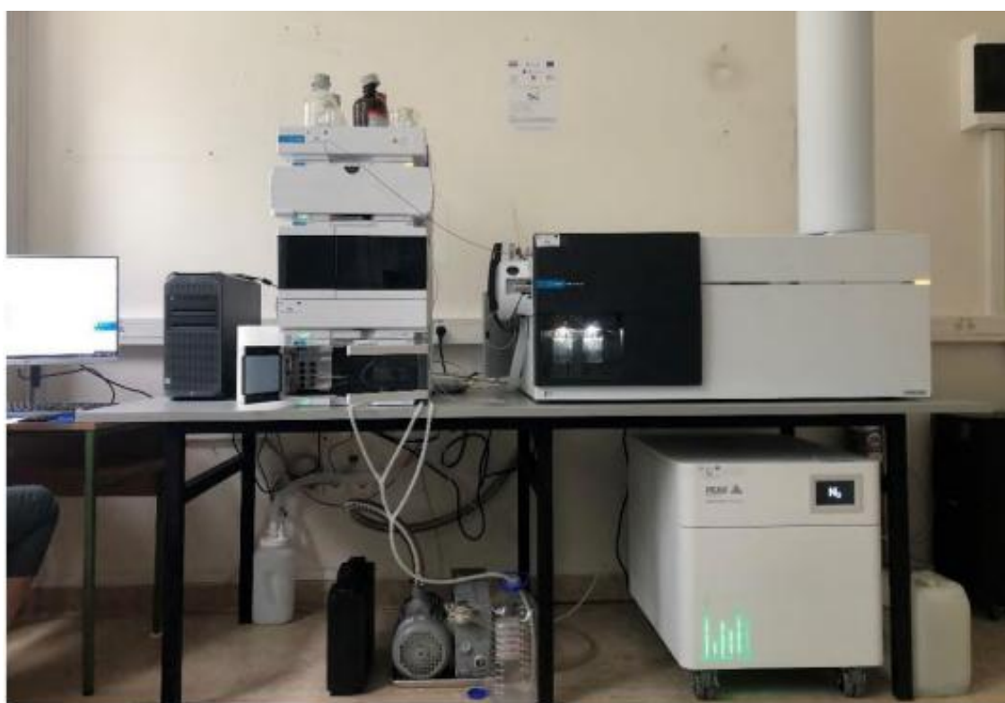
Slika 17. Prikaz uređaja Agilent 6530 LC/MS Q-TOF
