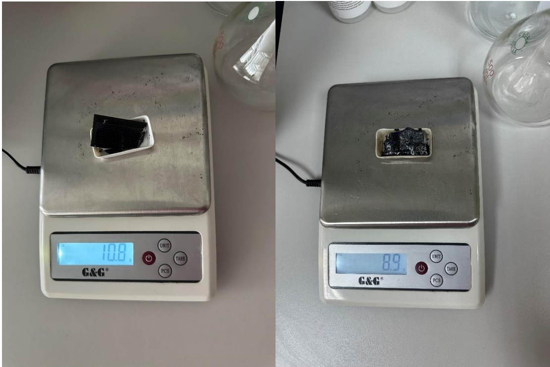
Slika 13: Uzorak 1 prije i nakon zagrijavanja u peći
