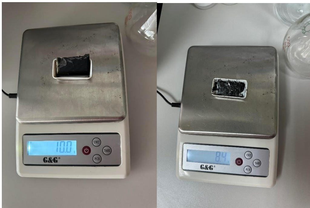
Slika 14: Uzorak 2 prije i nakon zagrijavanja u peći
