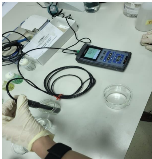
Slika 10. Mjerenje pH i električne vodljivosti
