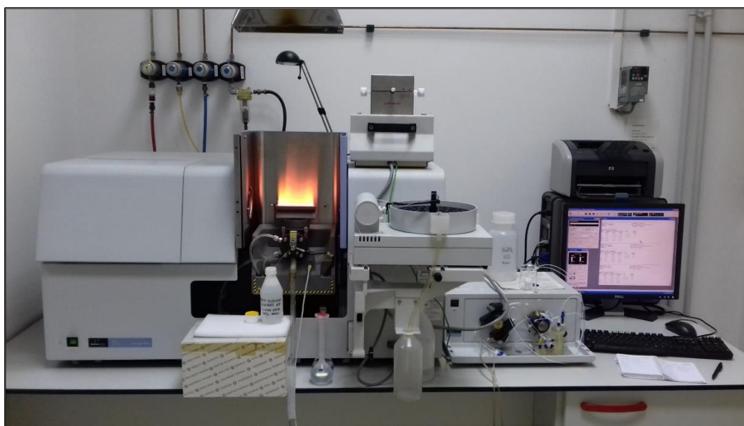
Slika 58. Određivanje elemenata u uzorcima vode i tla na atomskom apsorpcijskom spektrometru PerkinElmer AAnalyst 800, plamena tehnika – FAAS (autorska fotografija, 2023.)
