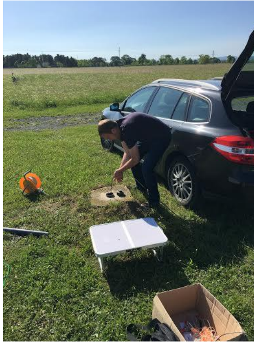
Slika 19. Spuštanje sonde u pijezometar
