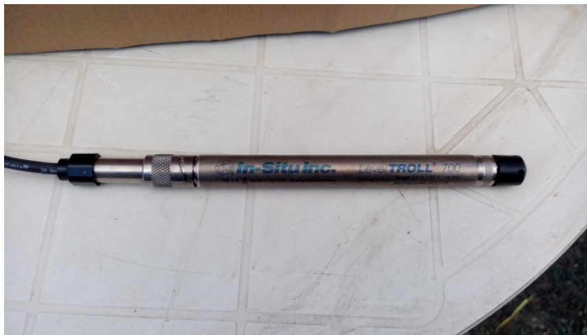
Slika 13. Sonda modela „Level TROLL 700“
