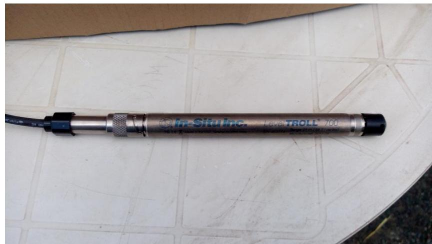
Slika 13. Sonda modela „Level TROLL 700“
