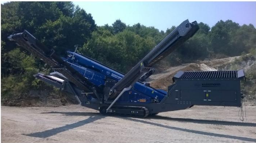
Slika 13. Postrojenje za sijanje s troetažnim sitom
