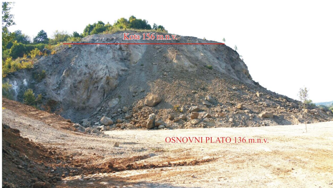
Slika 22. Izgled jugoistočnog dijela kamenoloma nakon prvog proizvodnog miniranja
