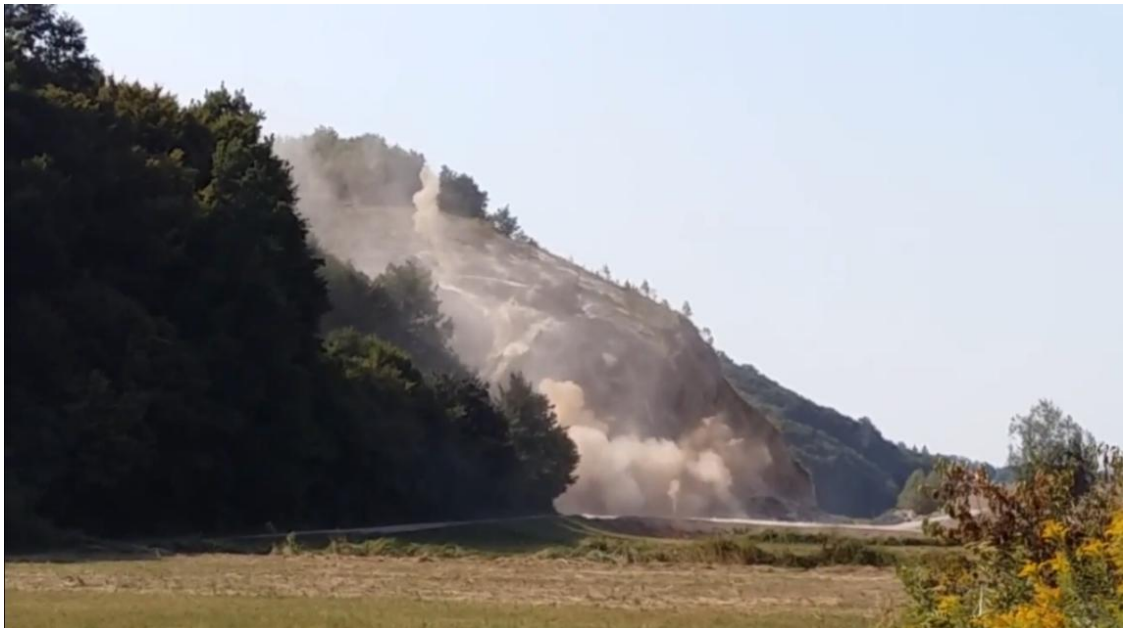
Slika 21. Minsko polje tijekom prvog proizvodnog miniranja
