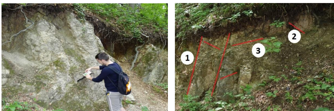
Slika 28. Detalji s treće lokacije s naznačenim glavnim familijama diskontinuiteta
