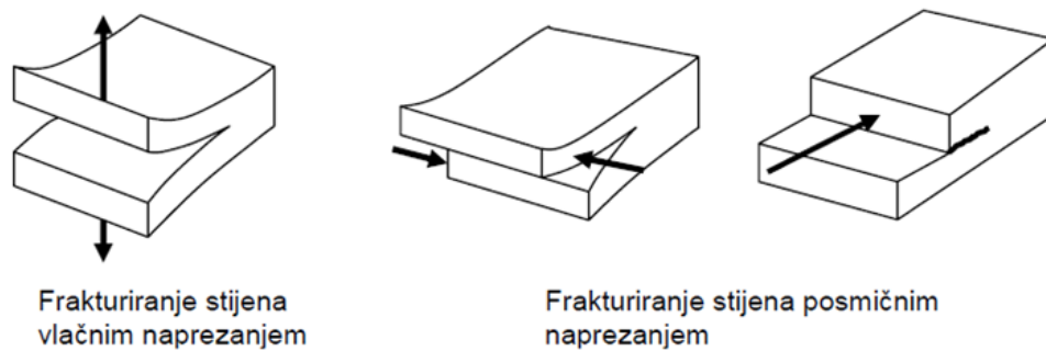
Slika 5. Nastajanje diskontinuiteta (Vrkljan, 2003)
