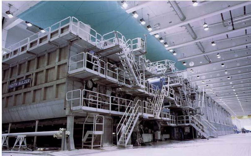
Slika 4. Stroj za proizvodnju papira
