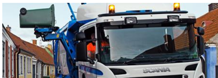
Slika 9. Kamion s bočnim načinom sakupljanja otpada [12]
