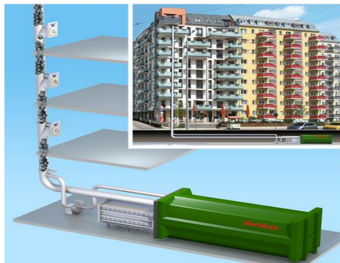
Slika 7. Postrojenje za pneumatski transport otpada [11]
