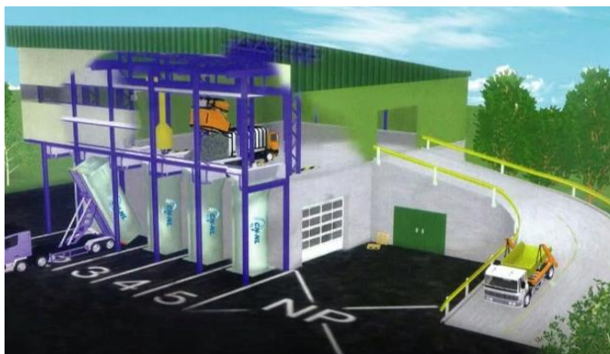
Slika 28. Vertikalni način izvedbe pretovarne stanice [35]
