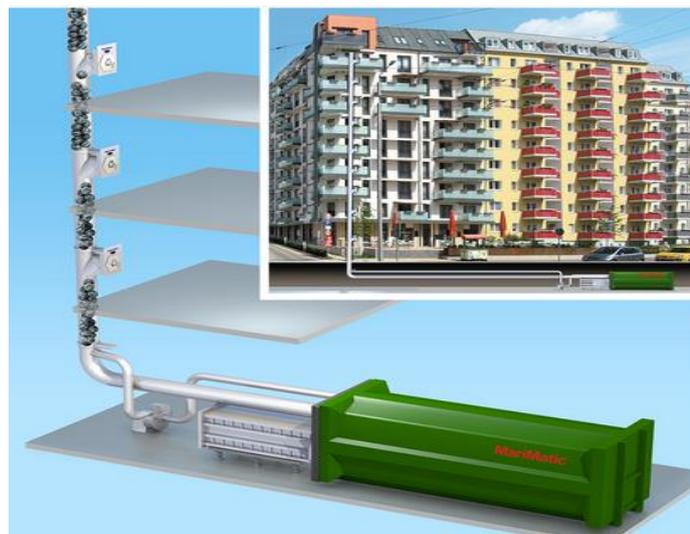
Slika 7. Postrojenje za pneumatski transport otpada [11]
