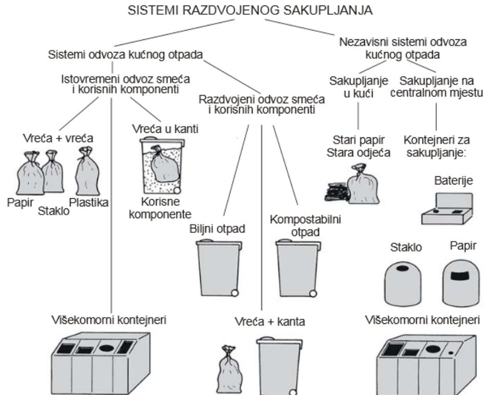
Slika 12. Sistem odvojenog sakupljanja komponenti komunalnog otpada [17]
