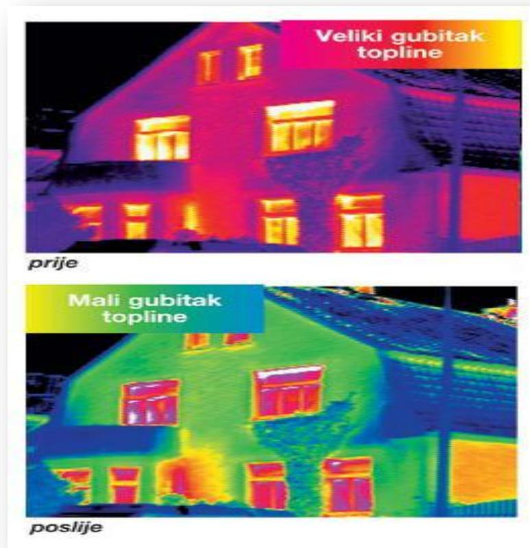
Slika 8: Usporedba termograma toplinski neizolirane zgrade prije rekonstrukcije i nakon izvedbe toplinske zaštite (Energetski institut Hrvoje Požar-EIHP)
