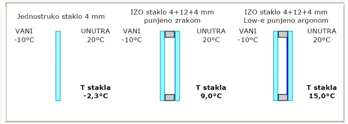
Slika 6: Temperature na unutarnjoj strani stakla ovisno o vrsti ostakljenja
