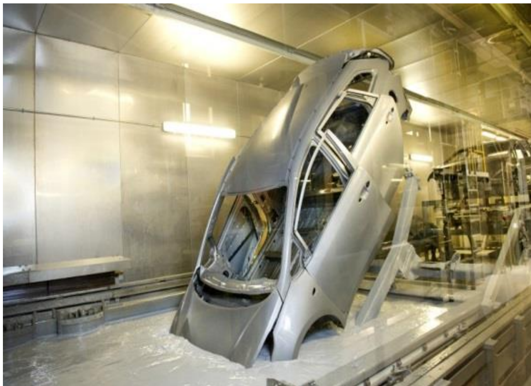
Slika 4. Stavljanje karoserije automobila u galvansku kupku u Slovačkoj [12]
