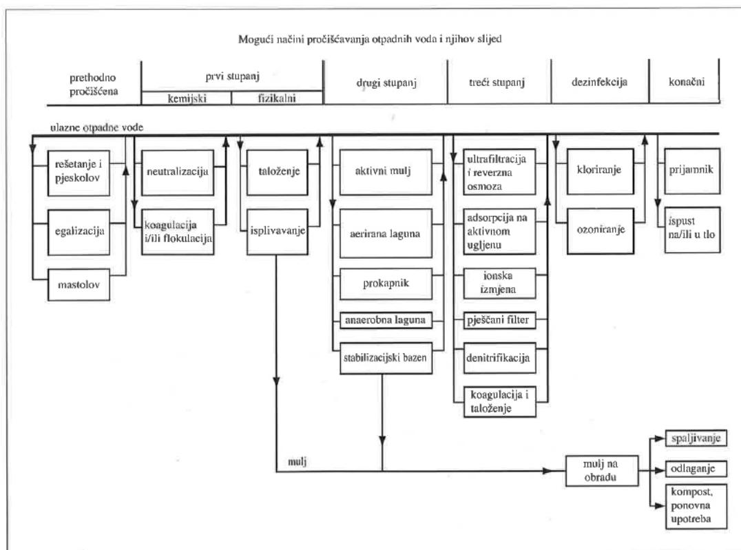
Slika 7. Dijelovi tehnološke linije pročišćavanja otpadnih voda [8]
