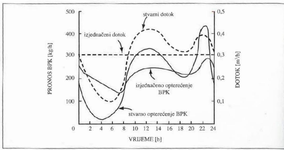
Slika 8. Protok i opterećenje organskom tvari prije i nakon izjednačavanja [8]
