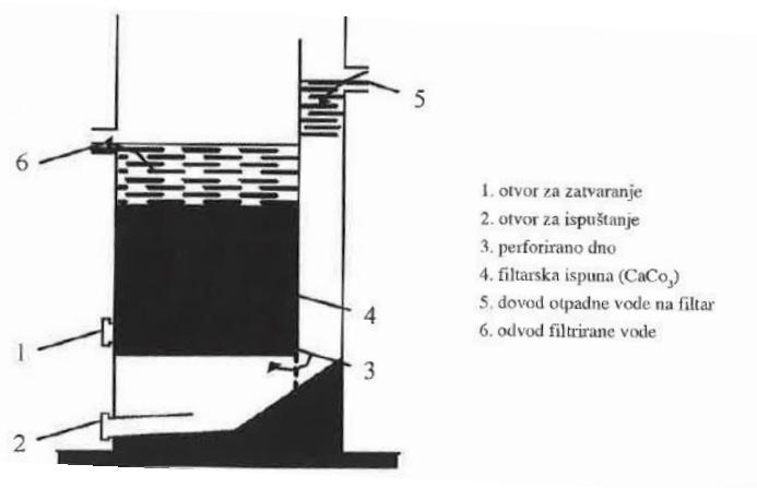
Slika 9. Neutralizacija na filtarnom sloju vapnenca [8]
