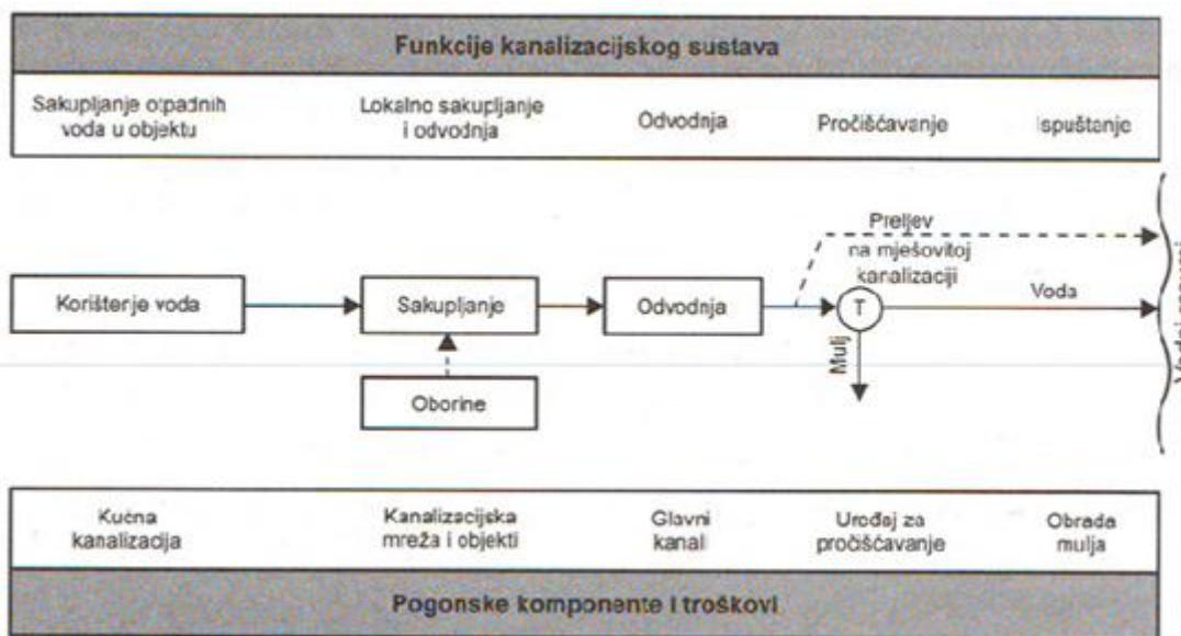
Slika 1. Osnovni dijelovi sustava za gospodarenje otpadnim vodama u naseljenim područjima [1]
