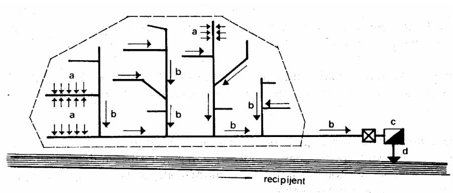
Slika 3. Osnovni elementi kanalizacijskog tehnološkog sustava [1]
