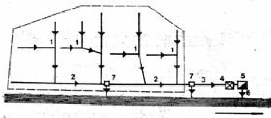
Slika 4. Mješoviti tip odvodnje [1]
