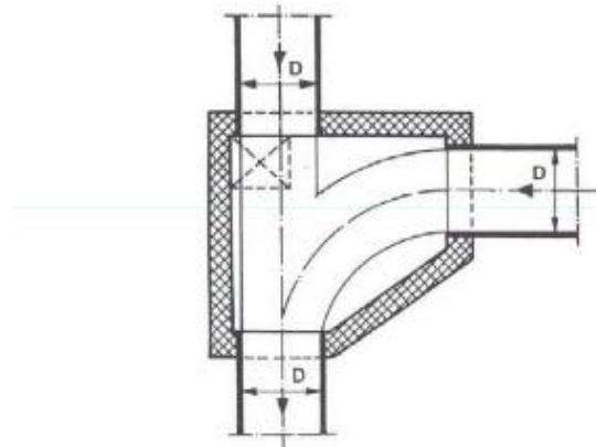
Slika 11. Spajanje većih kanala unutar betonskog bloka [8]
