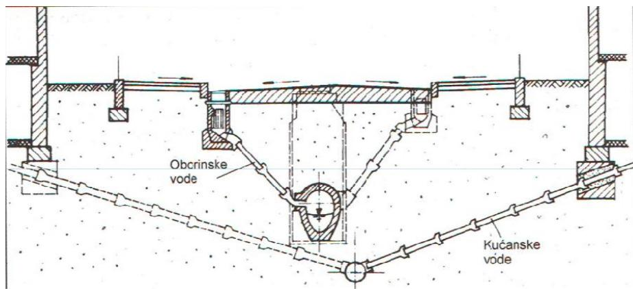
Slika 7. Karakterističan poprečni presjek prometnice s izgrađenim razdjelnim tipom odvodnje [7]
