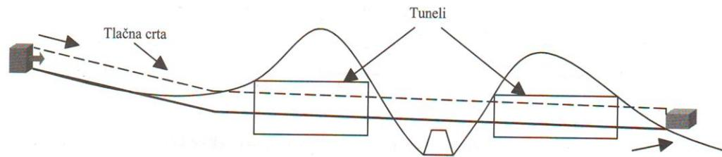
a) Dovodnik sa slobodnim vodnim licem;  $p \approx 1-3$  m vodnog stupca
