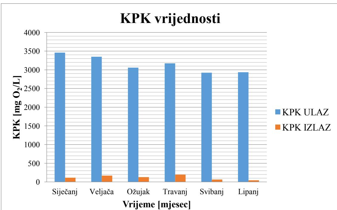
Slika 11. Usporedba prosječnih vrijednosti KPK na ulazu i izlazu iz uređaja za pročišćavanje otpadne vode za period od siječnja do lipnja 2016.
