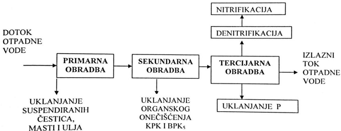
Slika 1. Shematski prikaz postupaka obrade otpadne vode [8] [17]
