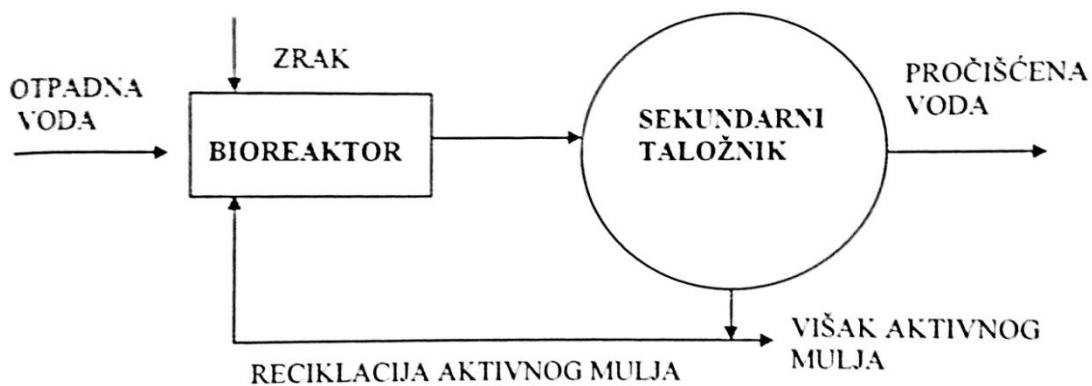
Slika 5. Shematski prikaz sustava za aerobnu obradu otpadnih voda aktivnim muljem [26]
