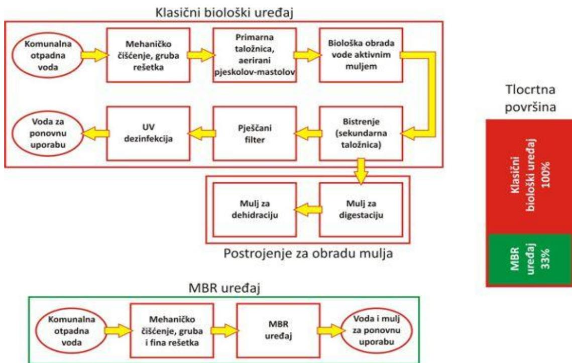
Slika 2. Usporedba klasičnog biološkog uređaja i MBR uređaja [18]
