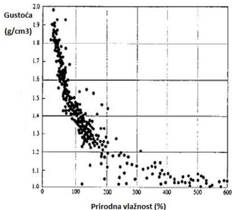
Slika 1. Odnos vlažnosti i gustoće podvodnog mulja [2]
