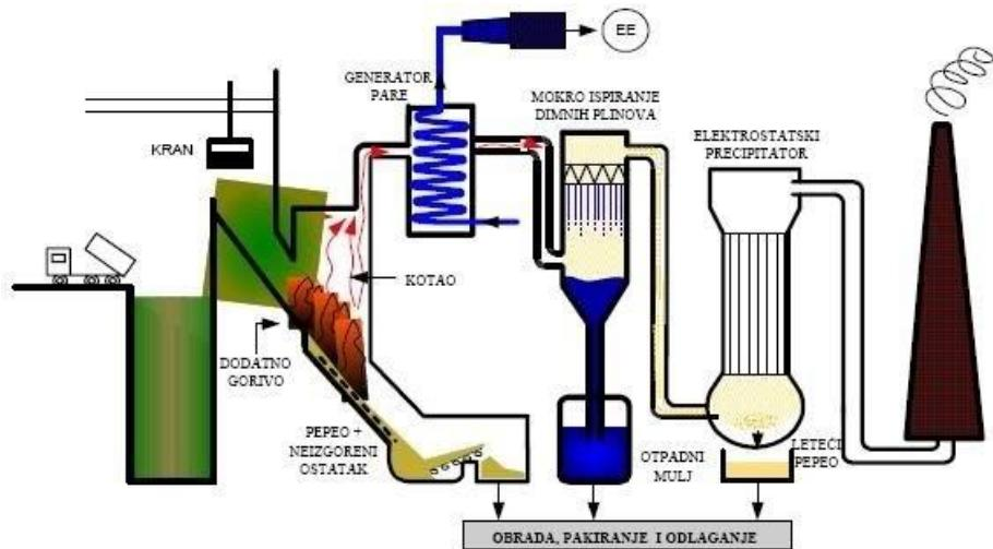
Slika 14. Pojednostavljeni prikaz spaljivanja otpadnog mulja [19]
