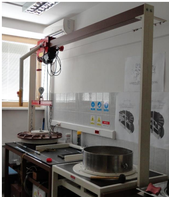
Slika 5. Veliki edometar Geotehničkog fakulteta
