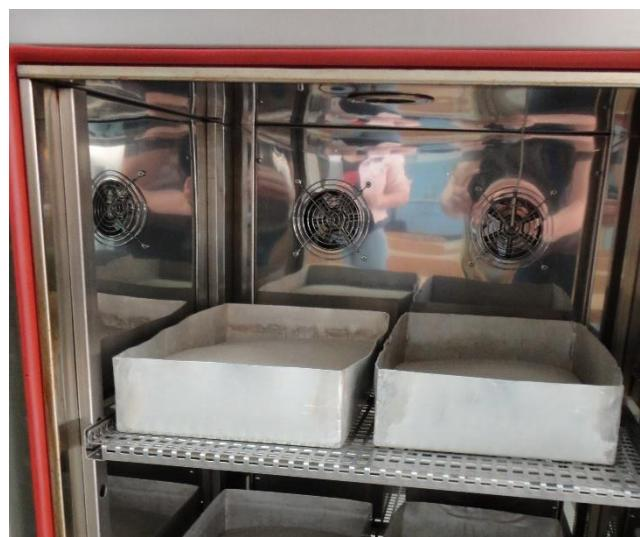
Slika 10. Uzorak pijeska stavljen na sušenje
