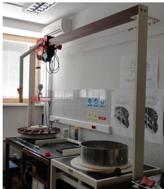
Slika 5. Veliki edometar Geotehničkog fakulteta
