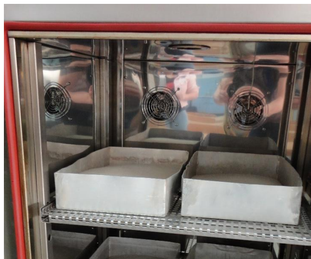
Slika 10. Uzorak pijeska stavljen na sušenje
