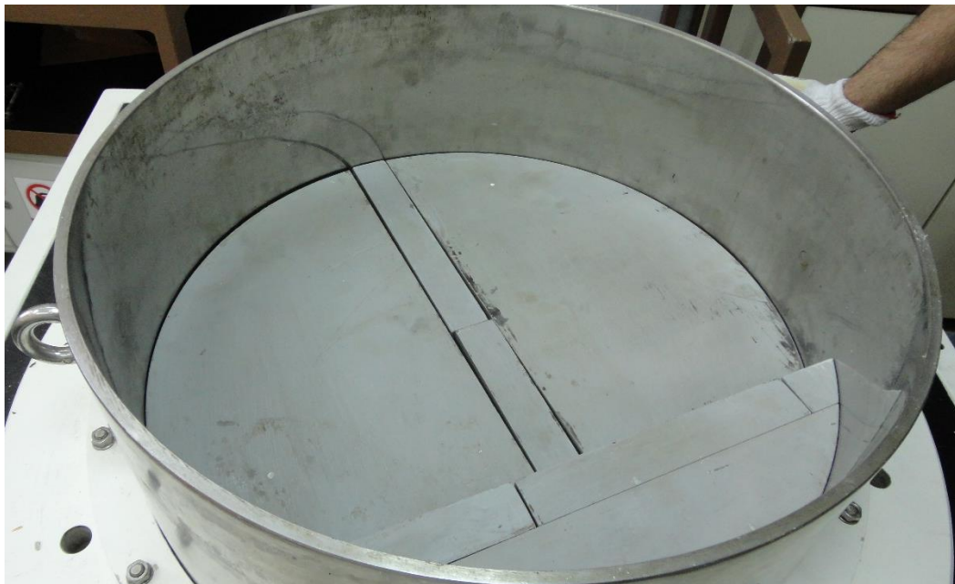
Slika 12. Ćelija edometra sa umetnutim metalnim pločama
