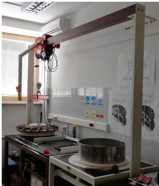
Slika 5. Veliki edometar Geotehničkog fakulteta
