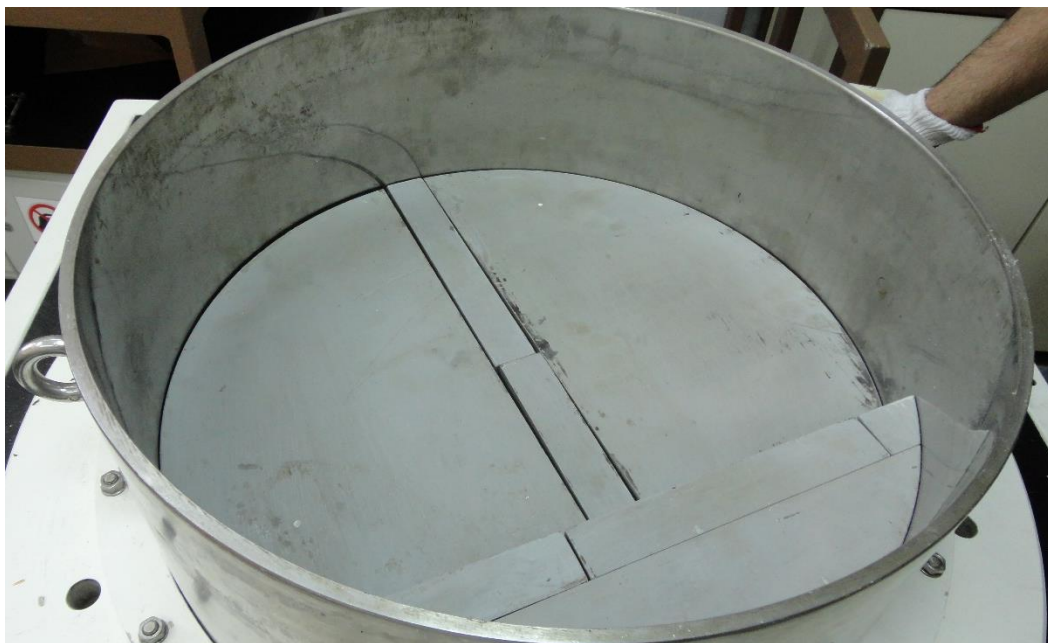
Slika 12. Ćelija edometra sa umetnutim metalnim pločama
