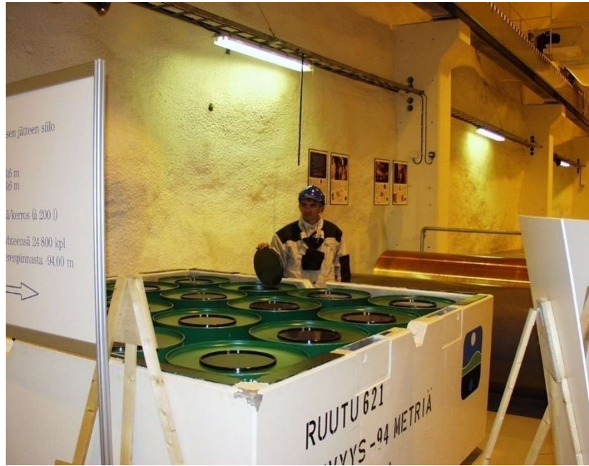
Slika 17. Kontejner sa spremnicima za RAO u odlagalištu Olkiluoto, Finska [1]
