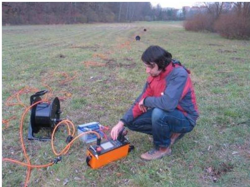
Slika 11. Prikaz geoelektričnog istraživanja [15]
