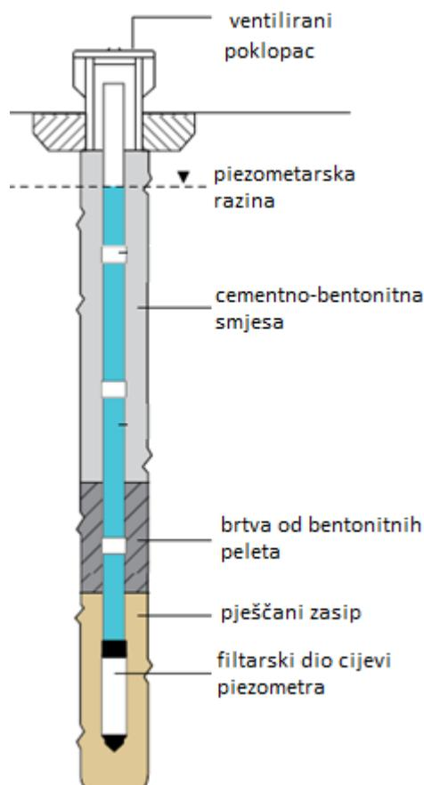
Slika 14. Prikaz konstrukcije piezometra otvorenog tipa [18]
