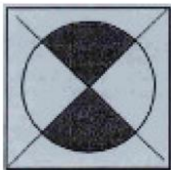
Slika 1.7 Tehnika uzorkovanja četvrtanjem [9]
