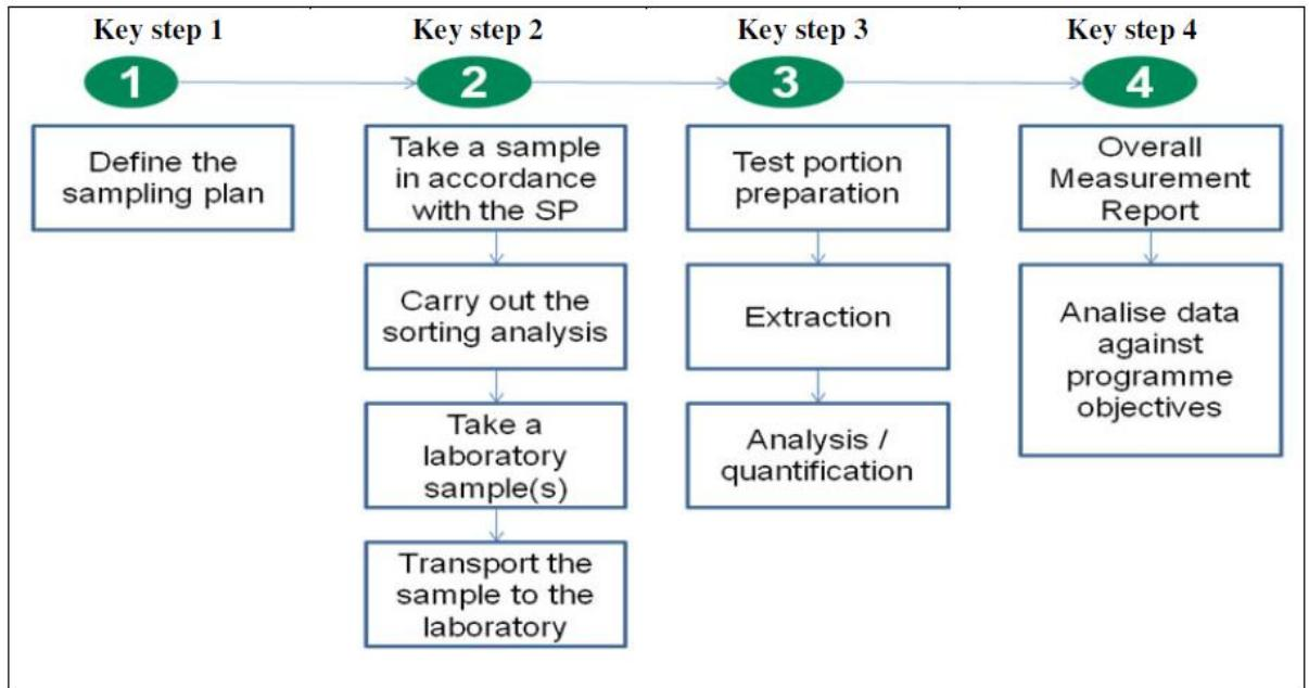
Slika 1.6 Opća shema prikupljanja i analize uzorka [9]
