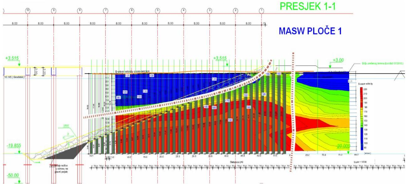
Slika 33. Profil posmičnih seizmičkih brzina MASW PLOČE 1, preklopljen na izvedbeni profil šljunčanih stupova
