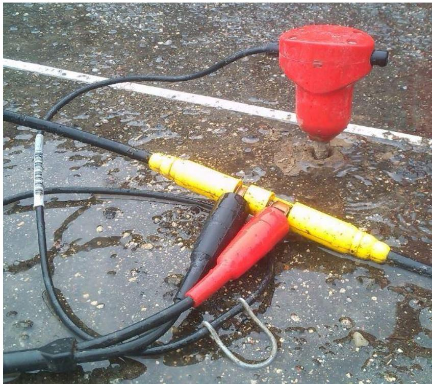
Slika 18. Vertikalni geofon niske frekvencije (4,5 Hz)
