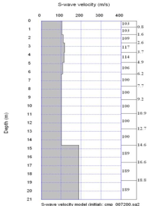
Slika 25. 1D- profil brzina posmičnih valova
