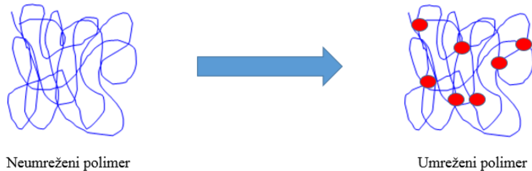
Slika 3. Prikaz umreženja tijekom procesa vulkanizacije
