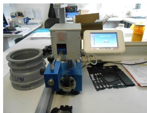
**Slika 44.** Uređaj za mjerene odbojne elastičnosti
