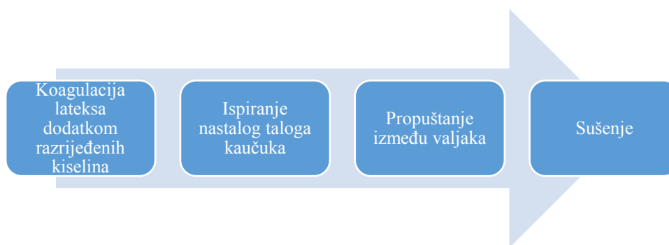
Slika 7. Shema dobivanja prirodnoga kaučuka
