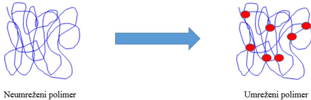
Slika 3. Prikaz umreženja tijekom procesa vulkanizacije
