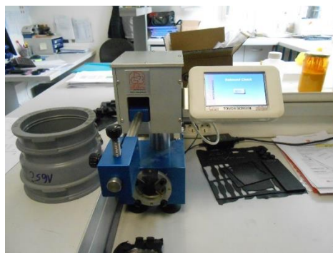
Slika 44. Uređaj za mjerenje odbojne elastičnosti
