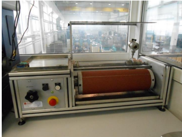
Slika 45. Uređaj za mjerenje habanja
