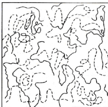
Slika 11. Mješljiva mješavina polimera A ( puna linija ) i B ( iscrtkana linija )
