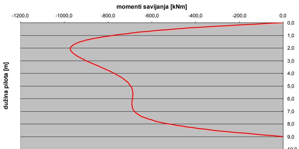
Slika 29. Dijagram momenta savijanja,  $M(x)$  za  $k=100\ 000 \text{ kN/m}^3$
