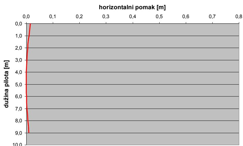
Slika 25. Dijagram horizontalnog pomaka, w(x) za  $k=50\ 000 \text{ kN/m}^3$
