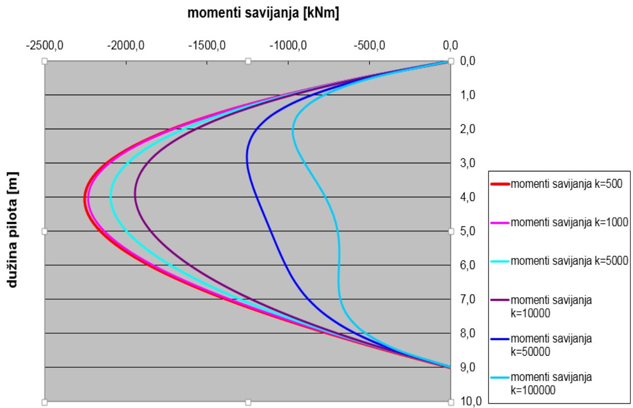
Slika 32. Dijagram momenata savijanja,  $M(x)$  uz promjenu koeficijenta podloge tla,  $k$
