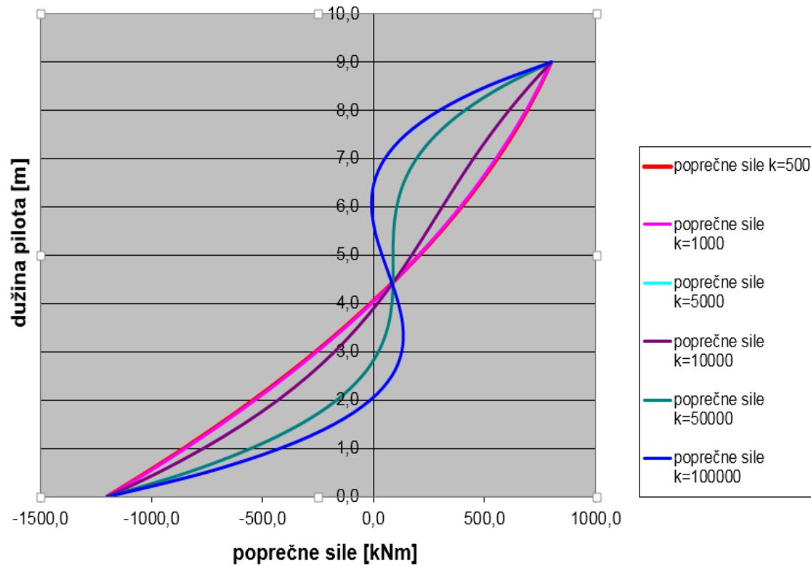
Slika 33. Dijagram poprečnih sila,  $Q(x)$  uz promjenu koeficijenta podloge tla,  $k$
