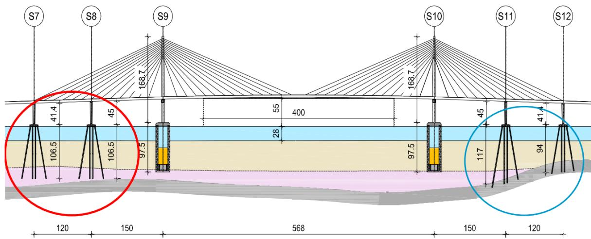
Slika 12. Shematski prikaz temelja stupova- zabijeni piloti
