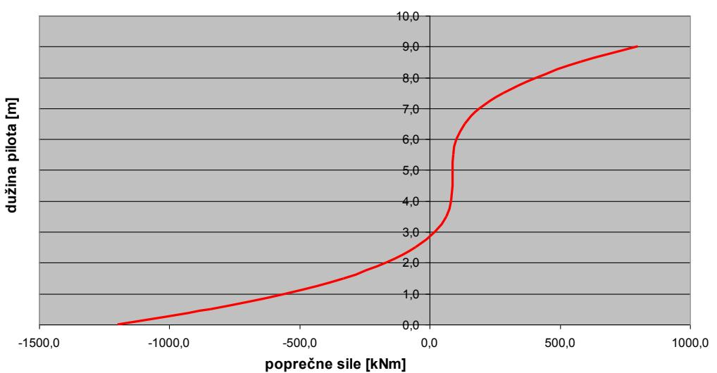
Slika 27. Dijagram poprečnih sila,  $Q(x)$  za  $k=50\ 000\ kN/m^3$
