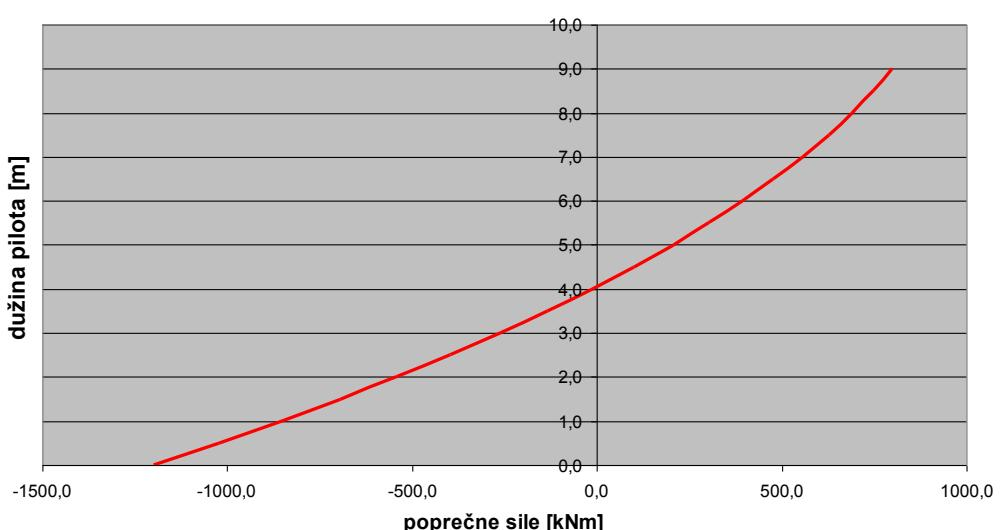
Slika 15. Dijagram poprečnih sila,  $Q(x)$  za  $k=500 \text{ kN/m}^3$
