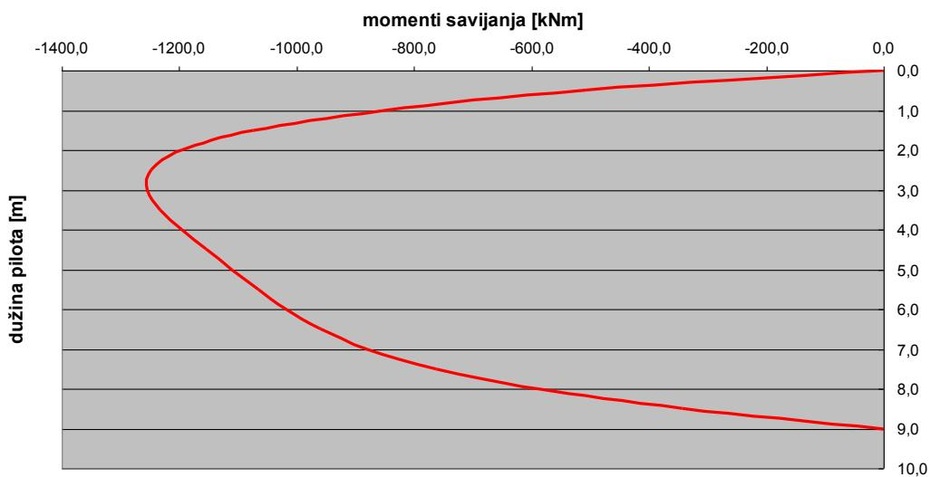
Slika 26. Dijagram momenta savijanja,  $M(x)$  za  $k=50\ 000\ kN/m^3$
