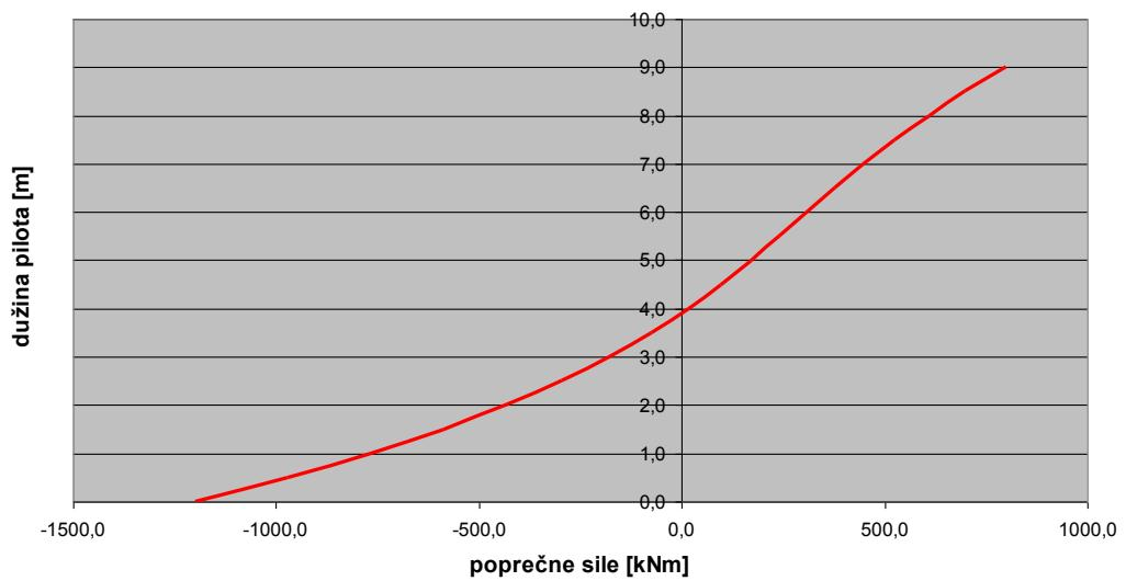
Slika 24. Dijagram poprečnih sila, Q(x) za  $k=10\ 000 \text{ kN/m}^3$
