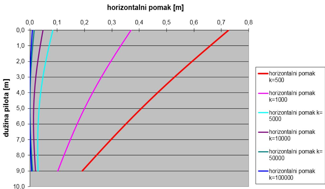
Slika 31. Dijagram horizontalnih pomaka,  $w(x)$  uz promjenu koeficijenta podloge tla, k
