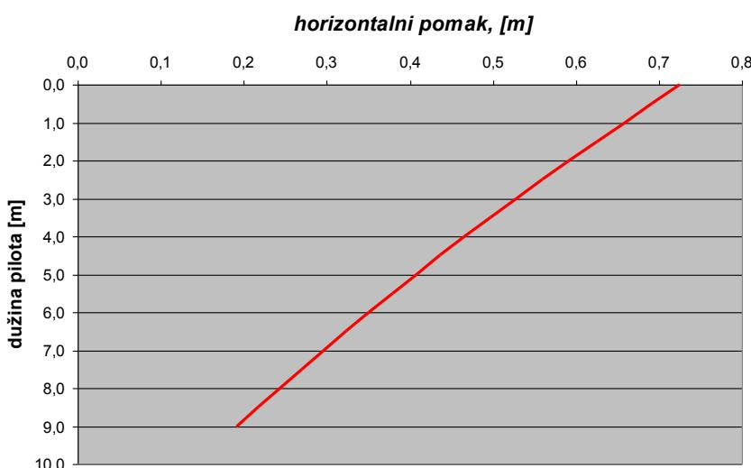
Slika 13. Dijagram horizontalnog pomaka,  $w(x)$  za  $k=500 \text{ kN/m}^3$
