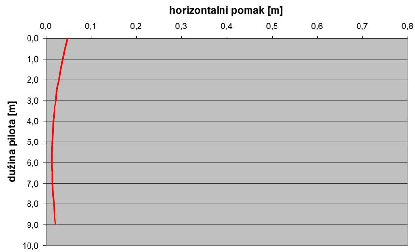
Slika 22. Dijagram horizontalnog pomaka,  $w(x)$  za  $k=10\ 000 \text{ kN/m}^3$
