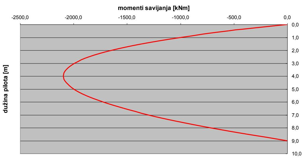
Slika 20. Dijagram momenta savijanja,  $M(x)$  za  $k=5000 \text{ kN/m}^3$
