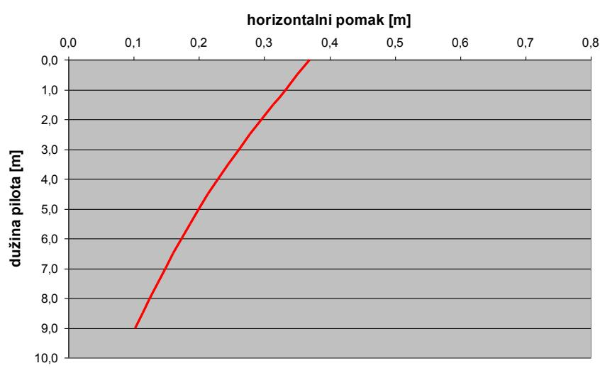
Slika 16. Dijagram horizontalnog pomaka,  $w(x)$  za  $k=1000 \text{ kN/m}^3$
