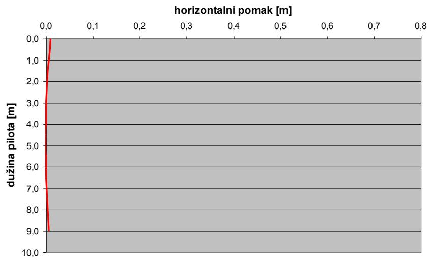
Slika 28. Dijagram horizontalnog pomaka,  $w(x)$  za  $k=100\ 000 \text{ kN/m}^3$
