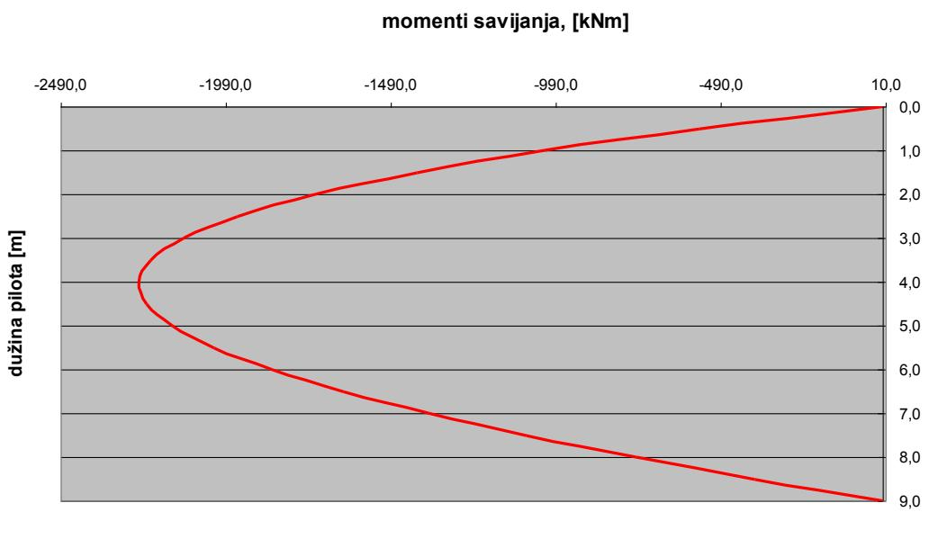
Slika 14. Dijagram momenta savijanja,  $M(x)$  za  $k=500 \text{ kN/m}^3$
