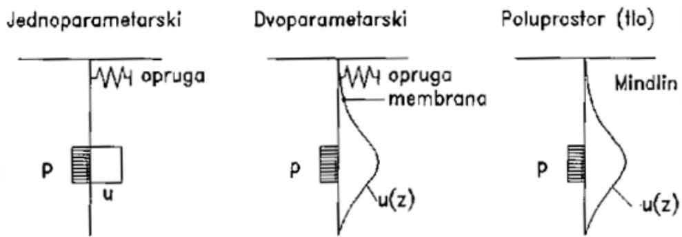
Slika 2. - *Prikaz dodatnih veza između nepoznatih funkcija pomaka  $u(z)$  i reaktivnih pritisaka tla  $p(z)$  u jednoperametarskom i dvoperametarskom modelu tla te Mindlin-ovom modelu*
