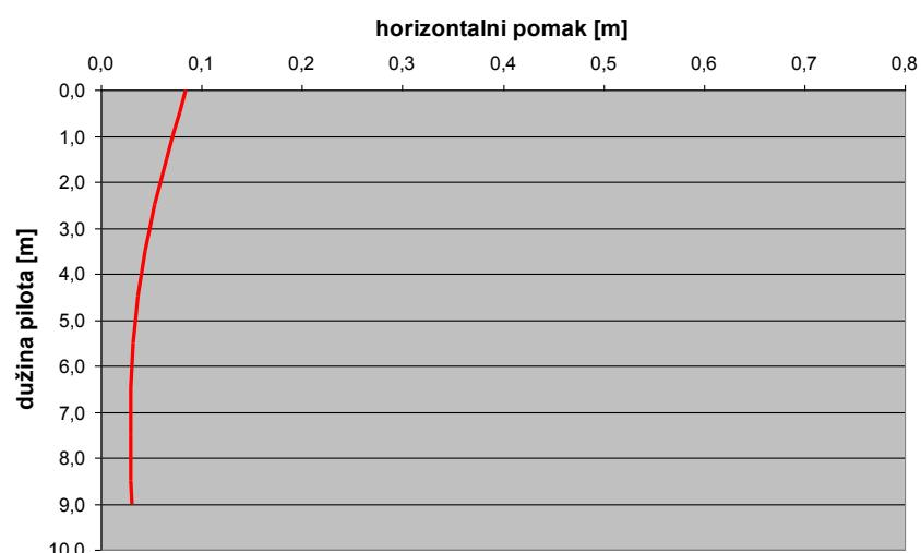
Slika 19. Dijagram horizontalnog pomaka, w(x) za  $k=5000 \text{ kN/m}^3$
