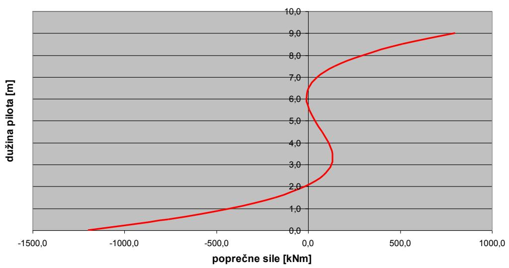
Slika 30. Dijagram poprečnih sila, Q(x) za  $k=100\ 000\ \text{kN/m}^3$
