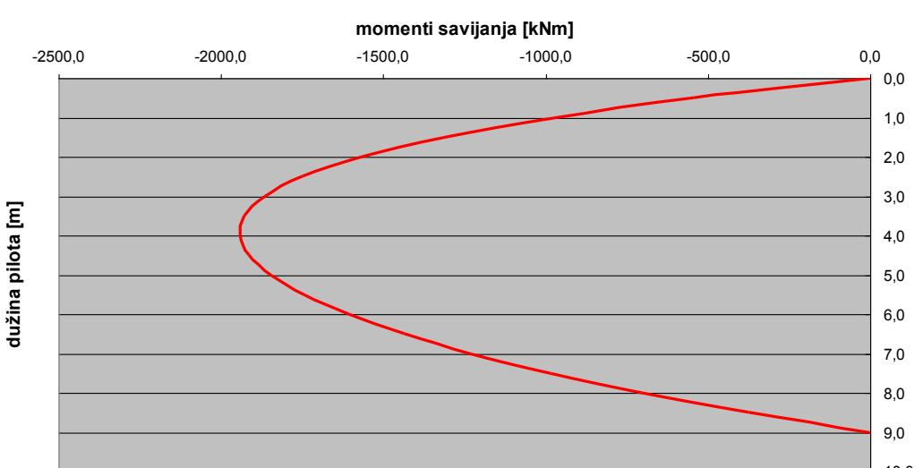
Slika 23. Dijagram momenta savijanja,  $M(x)$  za  $k=10\ 000 \text{ kN/m}^3$
