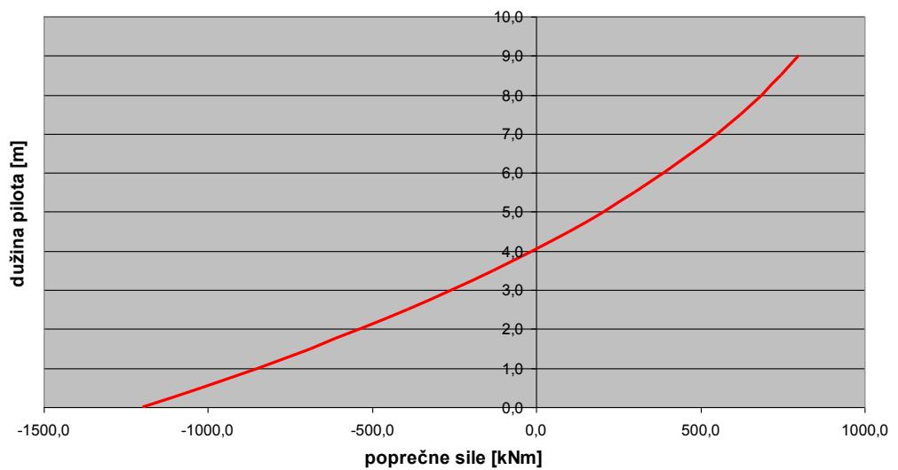
Slika 18. Dijagram poprečnih sila, Q(x) za  $k=1000 \text{ kN/m}^3$
