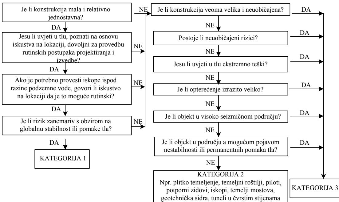
Slika 17.: Dijagram toka za određivanje geotehničke kategorije
