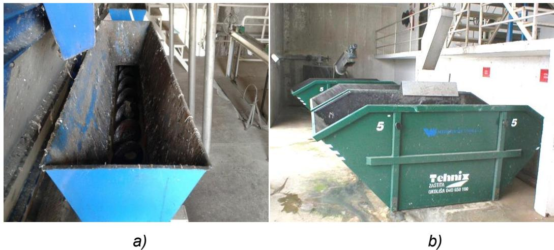
**Slika 5.** a) cjevasti pužni transporter za otpad s automatskimi rešetkama
