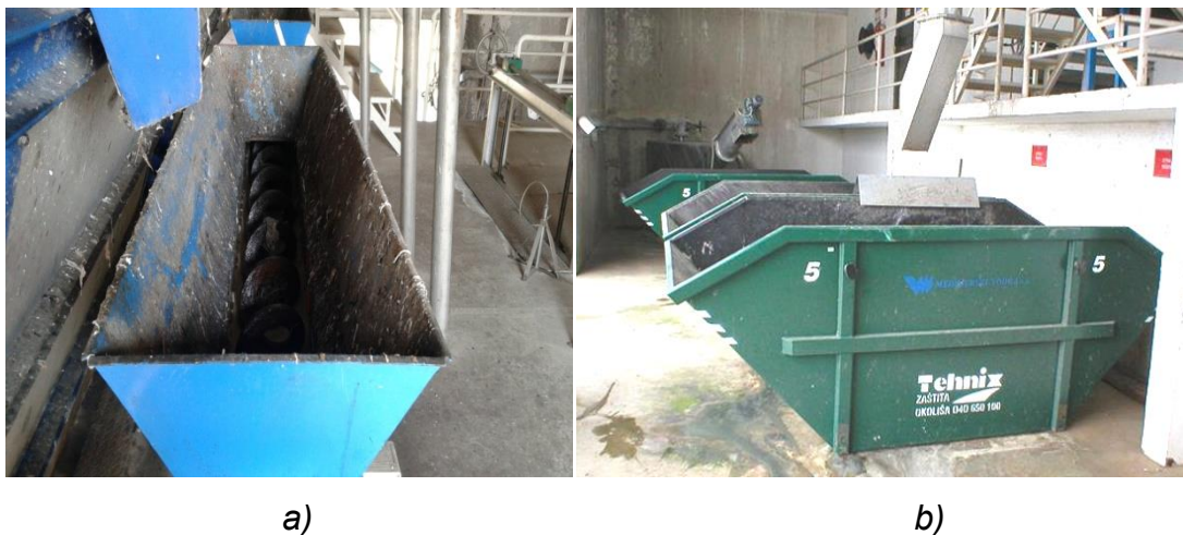
Slika 5. a) cjevasti pužni transporter za otpad s automatskih rešetki b) kontejneri za otpad s automatskih rešetki
