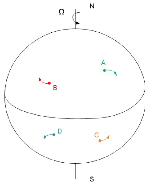
Slika 12. Smjer atmosferskih čestica na sjevernoj i južnoj hemisferi djelovanjem Coriolisove sile [12].
