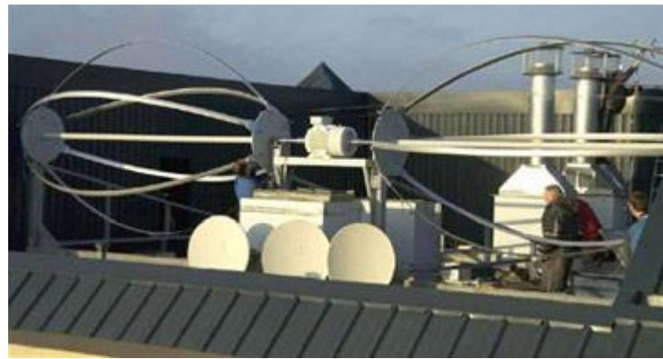
Slika 23. Horizontalna izvedba Darrieusove vjetroturbine [25].
