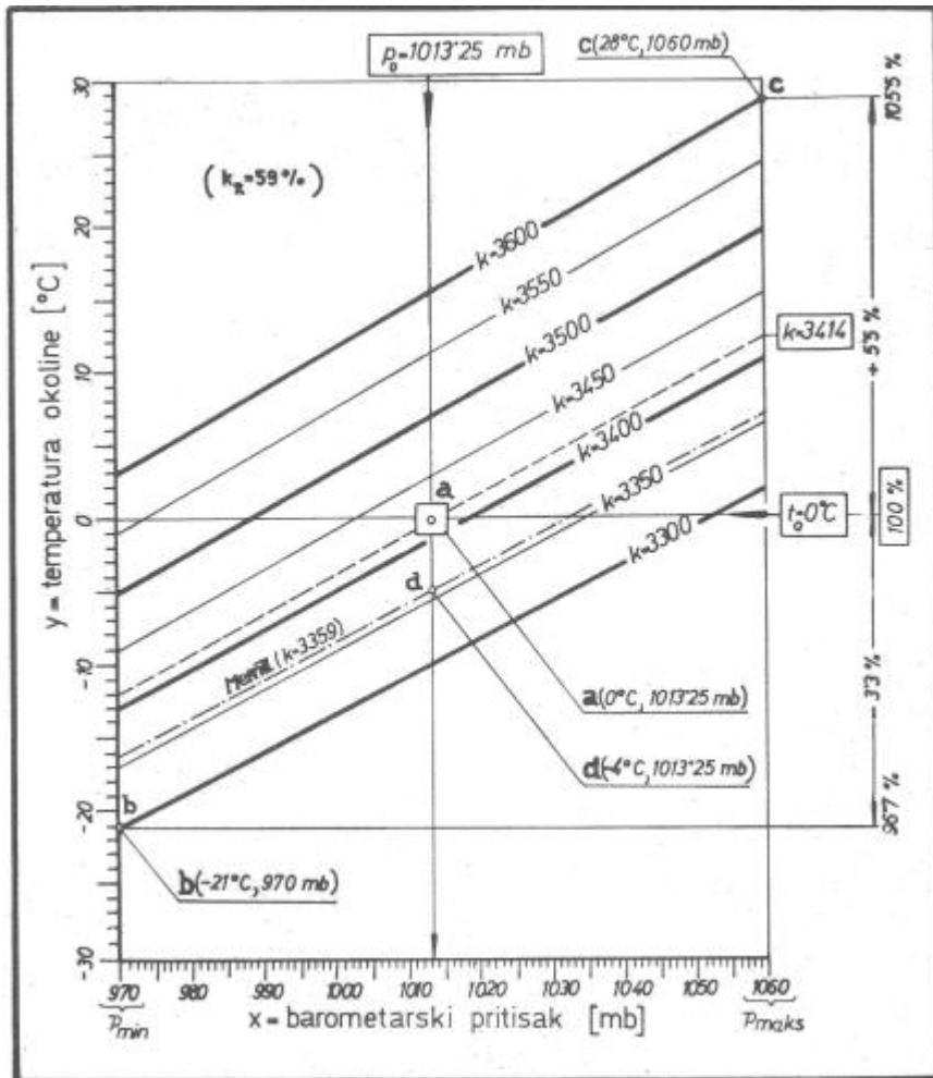
Slika 32. Ovisnost koeficijenta (k) o tlaku i temperaturi [20].
