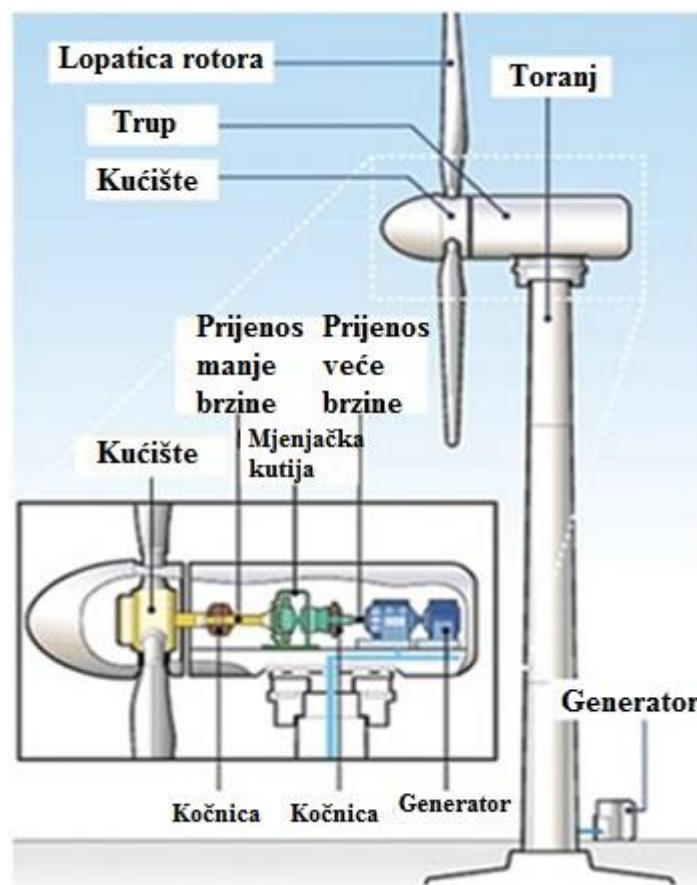
Slika 15. Dijelovi vjetroturbine [17].
