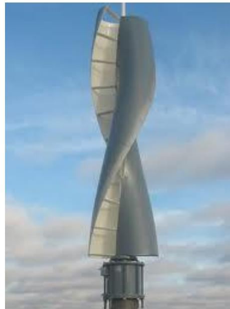
Slika 24. Savoniusova vjetroturbina [26].
