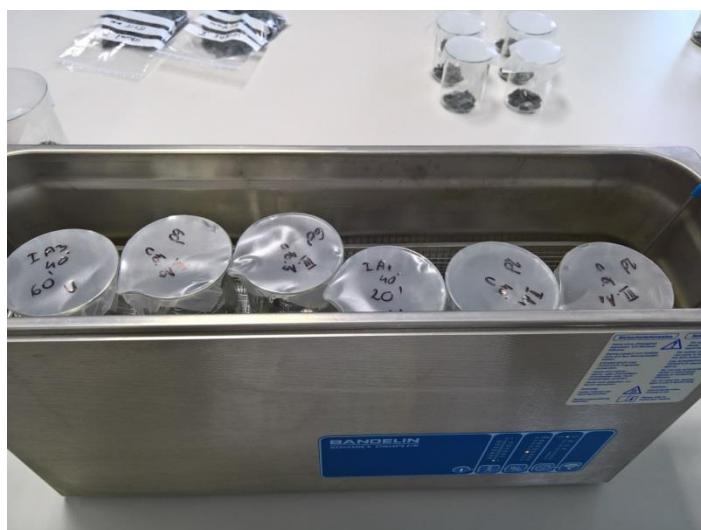
Slika 13 Ultrazvučna kupelj u radu
