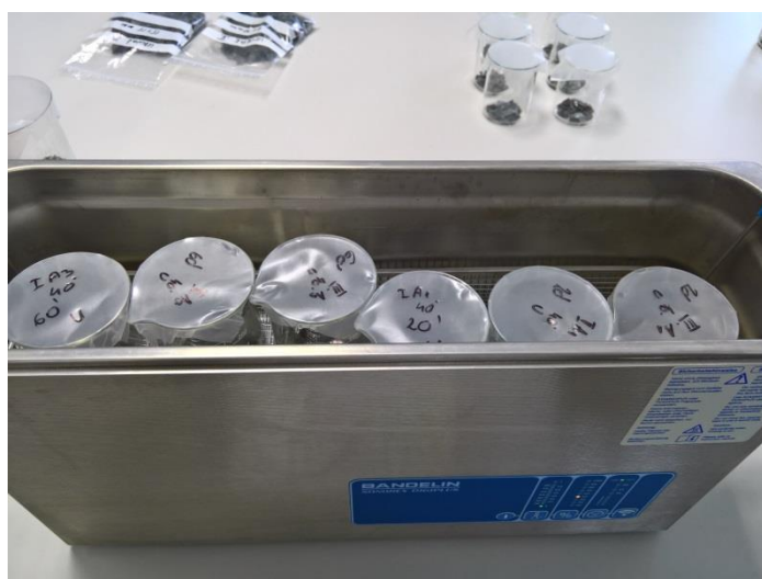
Slika 13 Ultrazvučna kupelj u radu
