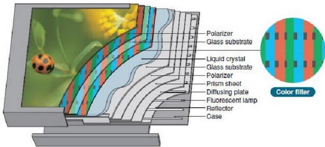
Slika 1 Shematski prikaz grade LCD zaslona (5)
