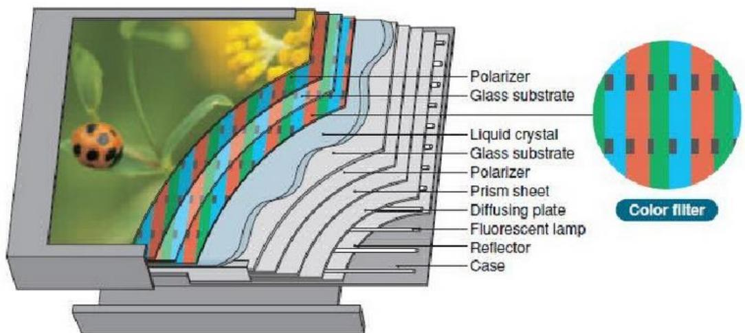
*Slika 1 Shematski prikaz grada LCD zaslona[3]*
