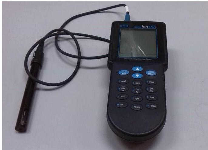
Slika 13. Konduktometar Hach Sension 156
