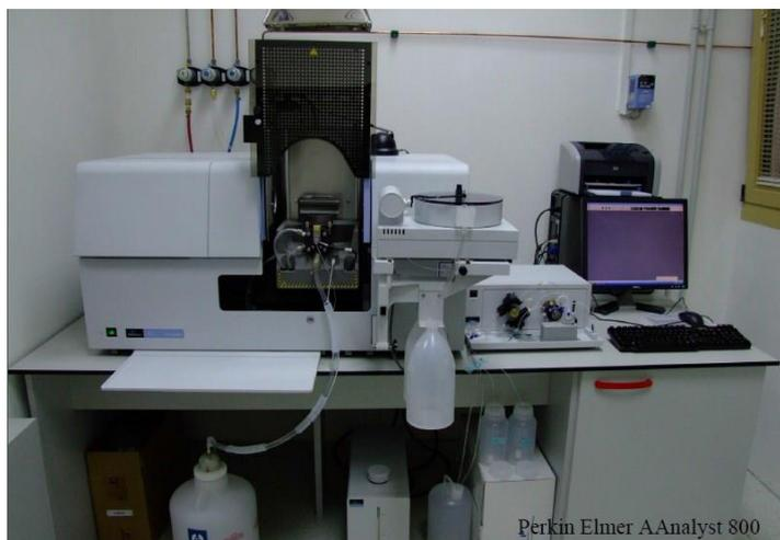
Slika 11. Uređaj Perkin Elmer AAnalyst 800 (spektrometar)
