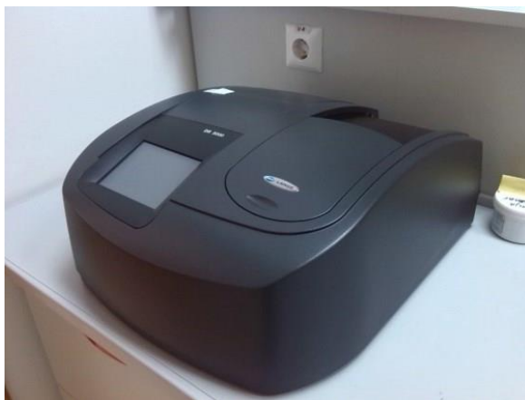
Slika 12. Uređaj Hach Lange DR 5000
